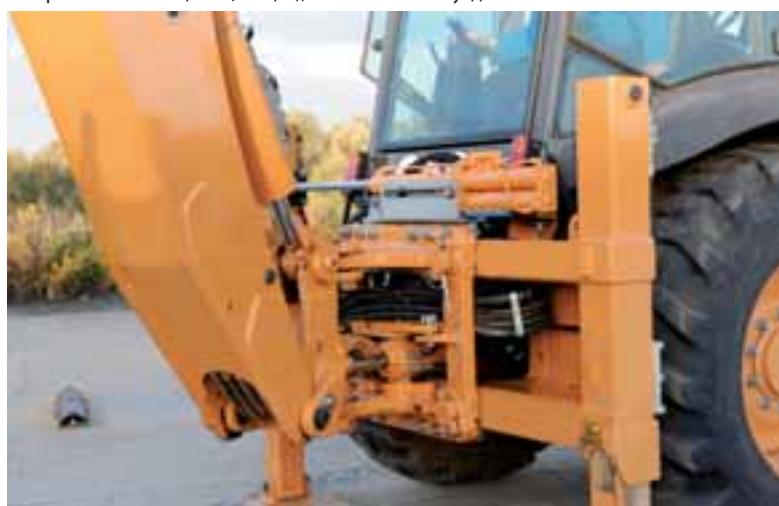
Быстро соединяемые гидравлические и механические муфты заводского изготовления.
