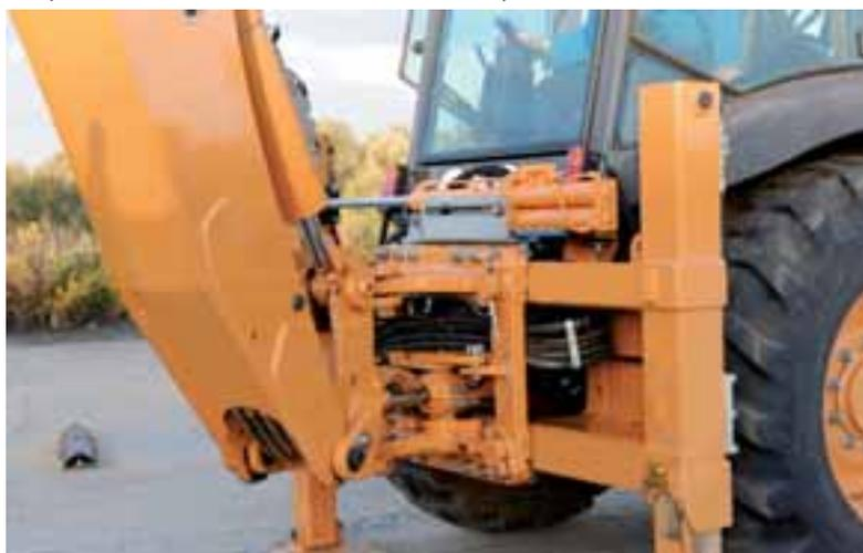
Быстросоединяемые гидравлические и механические муфты заводского изготовления.
