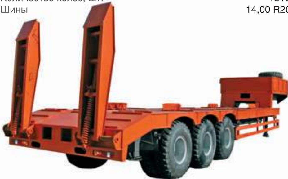
Полуприцеп-тяжеловоз предназначен для перевозки колесной и гусеничной техники, а также других нестандартных грузов по дорогам I–V технических категорий. Модель снабжена механическими трапами, оборудованными механическими помощниками подъема и опускания, для въезда на погрузочную платформу своим ходом под углом 14°. Кроме этого,
