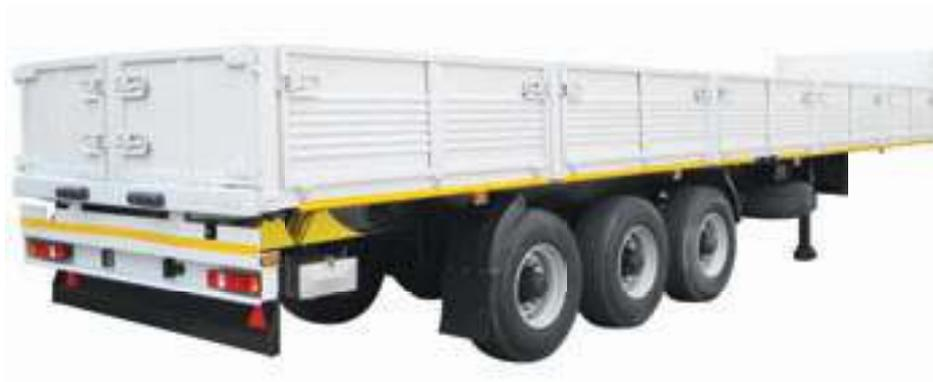
Предназначен для перевозки грузов в штучно-тарной упаковке. Обладает большим объемом кузова. Имеет откидные борта, обеспечивающие удобство при погрузке и разгрузке. Универсальность перевозимых грузов обеспечивает применимость в различных отраслях промышленности и строительства. Сцепной шкворень 2 дюйма. Мас-
