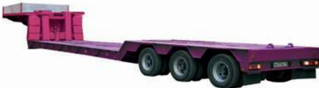
Полуприцеп-тяжеловоз низко-рамный с отсоединяемым гусаком ЧМЗАП-93371-000020 предназначен для транспортировки гусеничной техники. Его грузоподъемность — 50 тонн. Масса снаряжённого полуприцепа — 16 тонн. Особенностью данного полуприцепа является то, что заезд техники осуществляется спереди после отстыковки гусачной части. Преимуществом
