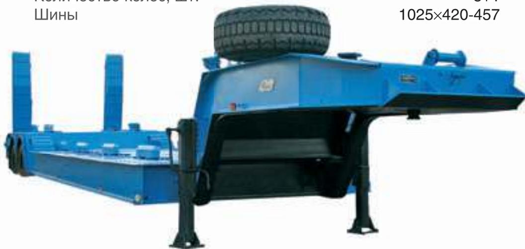
Полуприцеп-тяжеловоз предназначен для перевозки колёсной и гусеничной техники, а также других нестандартных грузов по дорогам I-V технических категорий. Модель снабжена трапами с механическими помощниками подъёма и опускания, для въезда на погрузочную платформу своим ходом. На
