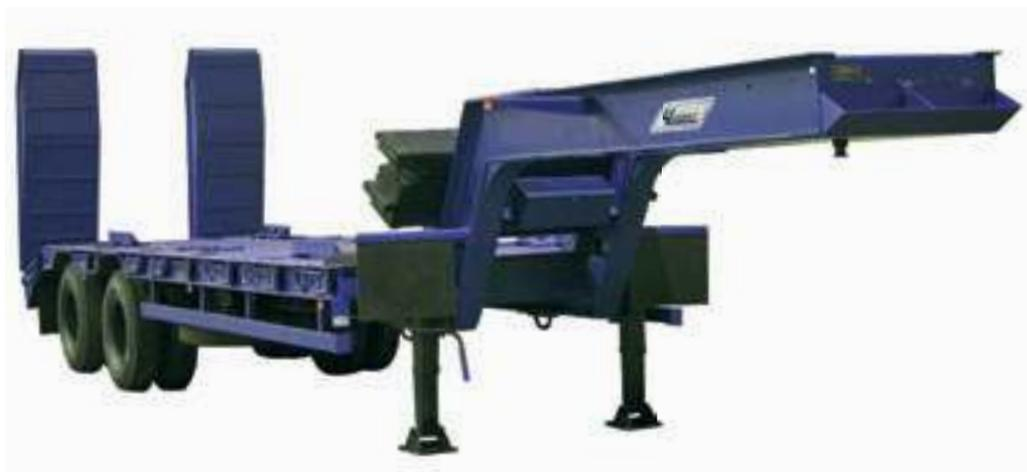
Полуприцеп-тяжеловоз предназначен для перевозки колёсной и гусеничной техники, а также других нестандартных грузов по дорогам I–V технических категорий. Модель снабжена механическими трапами, шириной 750 мм с механическими помощниками подъёма и опускания,
