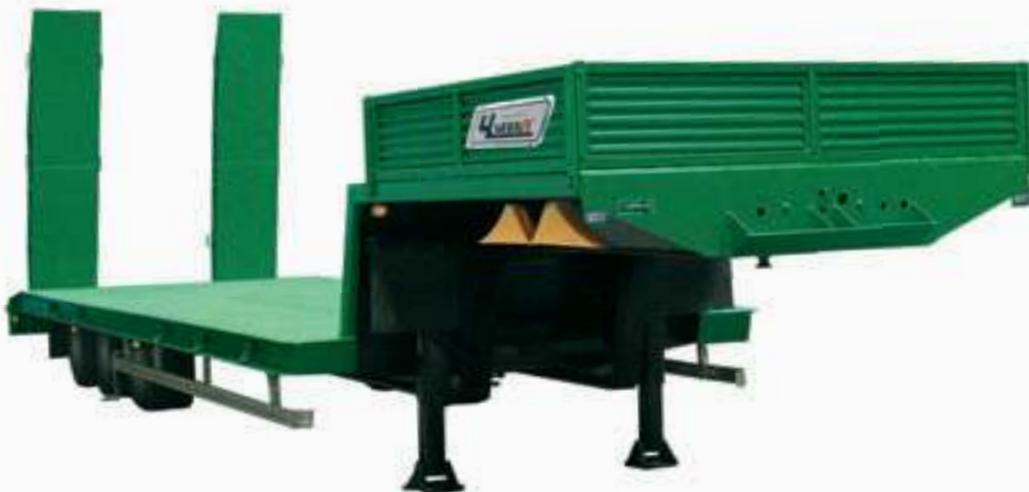
Полуприцеп-тяжеловоз с пониженной высотой грузовой платформы ЧМЗАП-9906.400000.052-МТШ отличается от базовой модели ЧМЗАП-9906.400000.052-МТ2 шириной платформы, которая составляет 3 150 мм. Полуприцеп рассчитан на эксплуатацию по дорогам I–III
