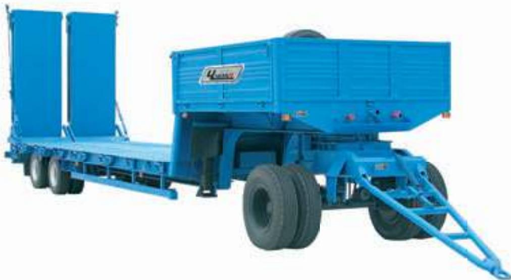
Прицеп предназначен для перевозки дорожно-строительной техники, колесно-гусеничных машин и крупногабаритных тяжеловесных неделимых грузов. Снаряжённая масса прицепа – 9 650 кг. Снабжен гидравлическими трапами для въезда на платформу своим ходом под углом 6° на первой ступени и 8° на второй ступе-
