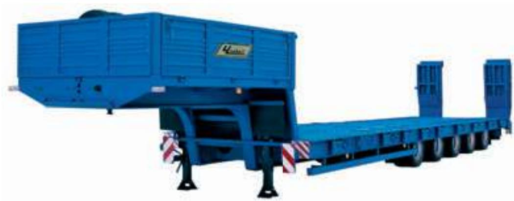
Полуприцеп ЧМЗАП-99904-0000011-ШУ отличается от своего аналога по спецификации 011 большей шириной платформы – 3 000 мм, которая с помощью уширителей доводится до 3 500 мм. Высота седельно-сцепного устройства тяга-
