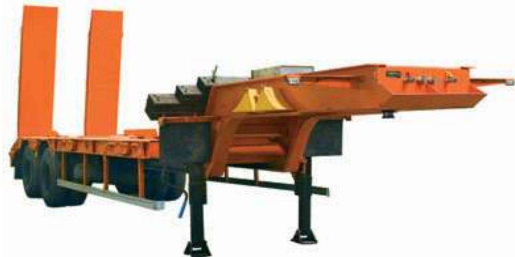
Полуприцеп-тяжеловоз предназначен для перевозки колёсной и гусеничной техники, а также других нестандартных грузов по дорогам I–V технических категорий. Модель снабжена механическими трапами, шириной 750 мм с механическими помощниками подъёма и опускания,
