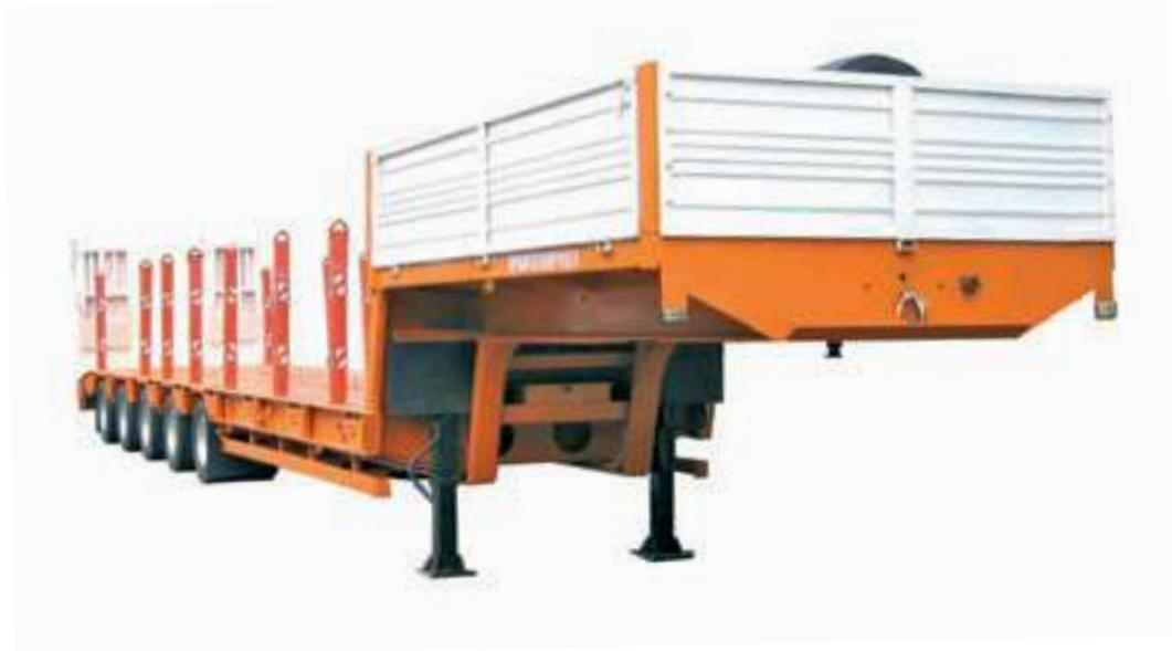
при перевозке крупногабаритных грузов полуприцеп оборудован уширителями рамы. Для перевозки длинномерных грузов полуприцеп оборудован съемными стойками-кониками, которые вставляются в гнезда рамы.
