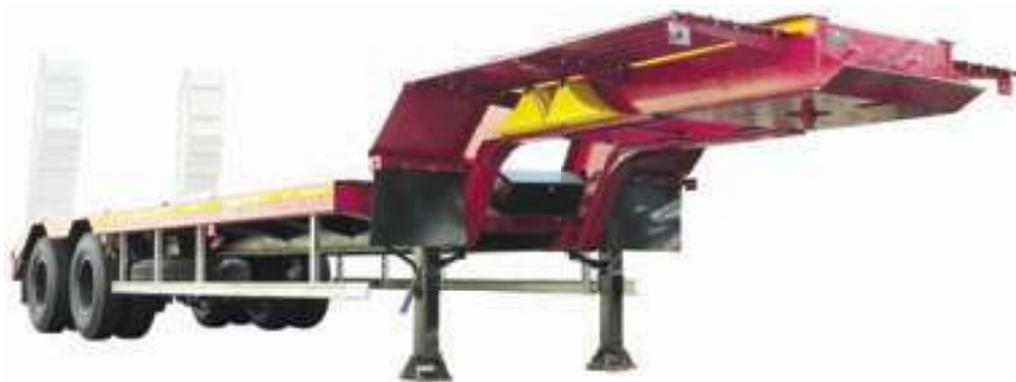
Полуприцеп предназначен для перевозки дорожно-строительной техники и других крупногабаритных неделимых грузов. 4-х рессорная балансирующая подвеска, с рессорой под осью. На полуприцепе установлены механические трапы шириной 450
