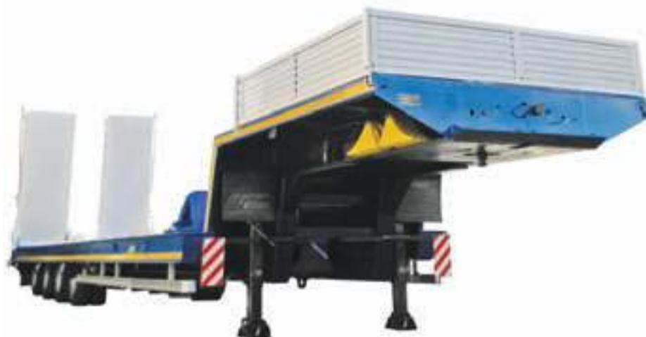
Полуприцеп-тяжеловоз имеет пневматическую подвеску BPW. 1, 2, 3 оси – неуправляемые, а 4-я ось – самоустанавливающаяся. Технические характеристики данной модели весьма привлекательны для потребителя. Масса перевозимого груза – 46 тонн, масса снаряженного полуприцепа 17 тонн, полная масса по-
