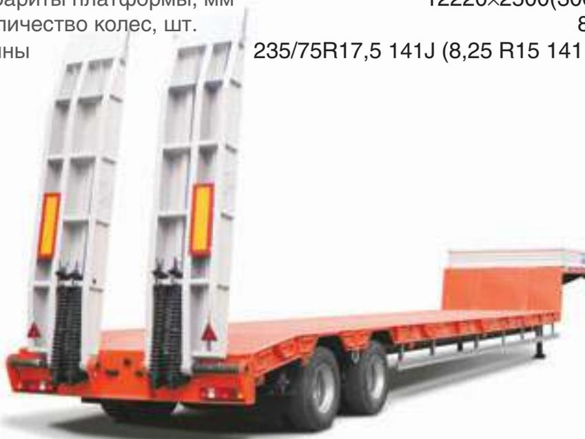
Полуприцеп предназначен для перевозки комбайнов и доминаторов, общей массой до 15 тонн, а также для перевозки колесной и гусеничной техники и других тяжеловесных грузов по дорогам I, II, III технических категорий. Подвеска рессорная. Трапы снабжены пружинным помощником подъема-опускания и ус-
