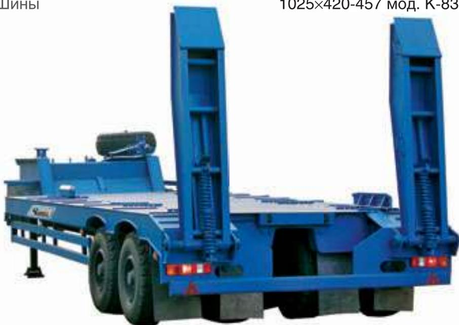
Полуприцеп-тяжеловоз имеет балансирную подвеску. Балансиры подвески на подшипниках скольжения закреплены осями на приваренные к лонжеронам рамы кронштейны. Сцепной шкворень 50,8 мм (2 дюйма). Рассчитан для
