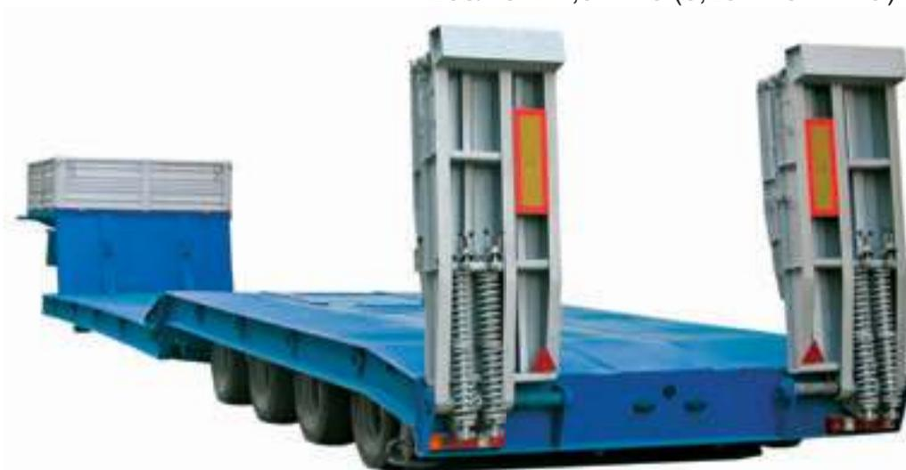
Полуприцеп-тяжеловоз предназначен для перевозки негабаритных по высоте грузов, тяжелой дорожно-строительной и гусеничной техники. 3, 4 оси – самоустанавливающиеся. Подвеска пневматическая BPW. Имеет собственно две грузовые платформы: низкорамную высотой 600 мм и платформу над колесами – 920 мм. На полуприцепе установлены двух-
