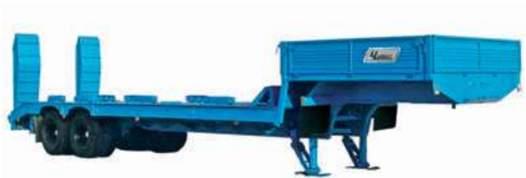
Полуприцеп-тяжеловоз предназначен для перевозки колесной и гусеничной техники, а также других нестандартных грузов по дорогам I–V технических категорий. Оснащен трапами с механическим помощником подъема-опускания, угол въезда по трапам 18 градусов. Снаряженная масса полуприцепа – 15 тонн. Сцепной шкворень 90 мм (3,5 дюйма). Может быть установлен шкворень диаметром 50,8 мм (2 дюйма), при этом полная масса
