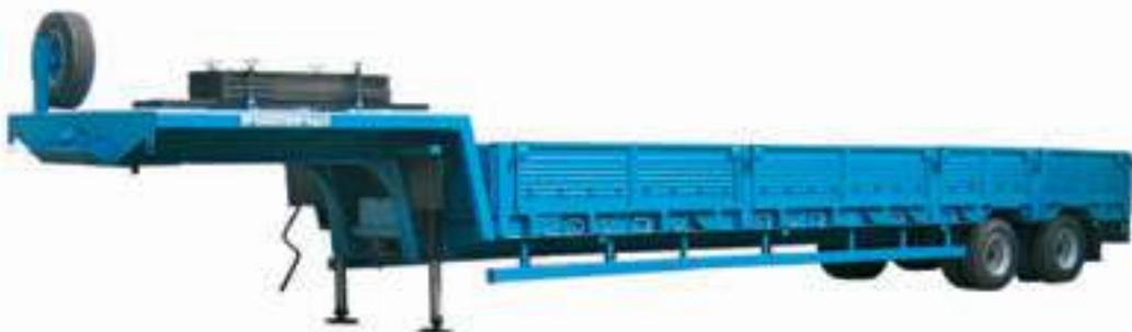
Прицеп предназначен для перевозки дорожно-строительной техники, колесно-гусеничных машин и крупногабаритных тяжеловесных неделимых грузов. Снаряженная масса полуприцепа 7,9 тонн. На грузовой платформе полуприцепа установлены съемные борта и стойки. Диаметр сцепного шкворня 2 дюйма (50,8
