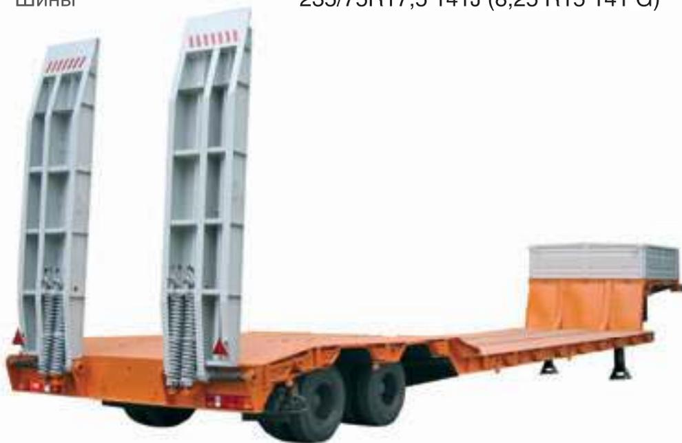
Особенностью полуприцепа ЧМЗАП-93853-000037НР в том, что он имеет две грузовые платформы: низкорамную высотой 630 мм и платформу над колесами 885 мм, что является преимущес-
