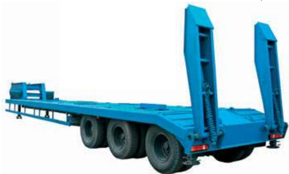
Полуприцеп-тяжеловоз ЧМЗАП-9906.40 по спецификации 070 предназначен для перевозки колесной и гусеничной техники и других тяжеловесных грузов по дорогам I, II и III технических категорий (СНиП 2.05.02-85). Передняя (гусачная часть) рамы полуприцепа рассчитана на
