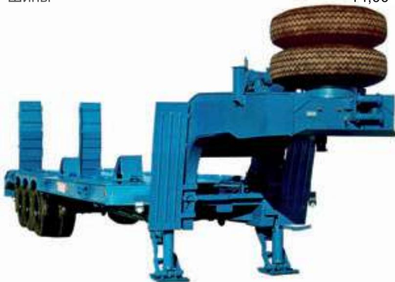
Полуприцеп-тяжеловоз предназначен для перевозки колесной и гусеничной техники, а также других нестандартных грузов по дорогам I–V технических категорий (СНиП 2.05.02-85). Сцепной шкворень полуприцепа имеет диаметр 100 мм. Ширина въездных трапов 600 мм, угол въезда по трапам 18°. На верхней плоскости гусач-
