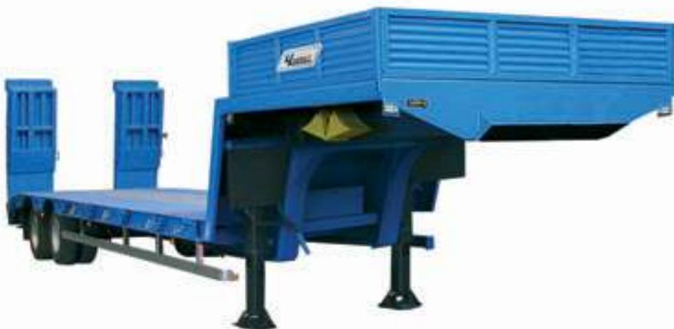
Полуприцеп предназначен для перевозки дорожно-строительной техники, колесно-гусеничных машин и крупногабаритных тяжеловесных неделимых грузов. Снаряжённая масса полуприцепа – 8 т. Снабжён двухступенчатыми трапами с пружинным помощником механизма подъема-опускания для въезда на
