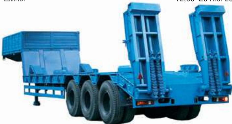
Полуприцеп-тяжеловоз предназначен для перевозки колесной и гусеничной техники, а также других нестандартных грузов в по дорогам I–V технических категорий. Стандартная ширина платформы 2,5 м, но с помощью боковых уширителей возможно увеличение погрузочной ширины до 3,15 м. Модель снабжена механическими трапами шириной 700 мм, оборудованными механическими помощниками подъ-
