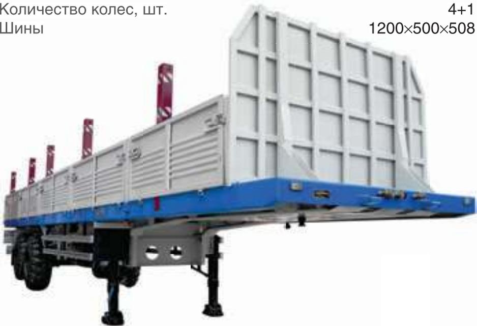
Предназначен для перевозки грузов в штучно-товарной упаковке, а благодаря раздвижным коникам — длинномерных грузов. Борта откидные, обеспечивающие удобство при погрузке и разгрузке. Сцепной шкворень 2 дюйма. Масса снаряжённого полуприцепа — 7 тонн.
