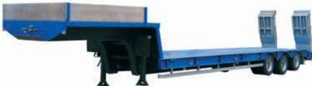
Полуприцеп-тяжеловоз с пониженной высотой грузовой платформы модели ЧМЗАП-9906.400000.052G45 предназначен для перевозки колёсной и гусеничной техники, а также нестандартных грузов собственной массой до 45 тонн.
