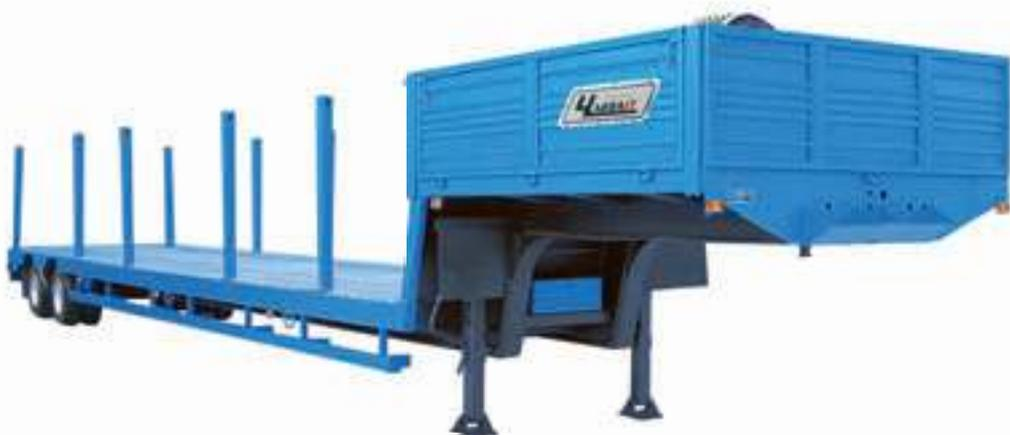
конфигурации 2S/2M. Масса снаряженного полуприцепа – 8,5 тонны. Трапы шириной 700 мм, имеют пружинный помощник подъема-опускания и устройство поперечного перемещения, которое дает возможность приспособить колею трапов под колею перевозимой техники. Допускается перевозка колесно-гусе-
