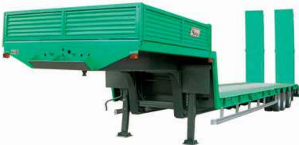
Предназначен для перевозки колёсной и гусеничной техники, а также нестандартных грузов собственной массой до 38 тонн. Снаряжённая масса полуприцепа составляет 11,5 т. Модель снабжена механическими трапами, оборудованными механическими помощниками подъёма-опускания, для въезда на платформу своим ходом. С помощью боковых уширителей возможно увеличение погрузочной
