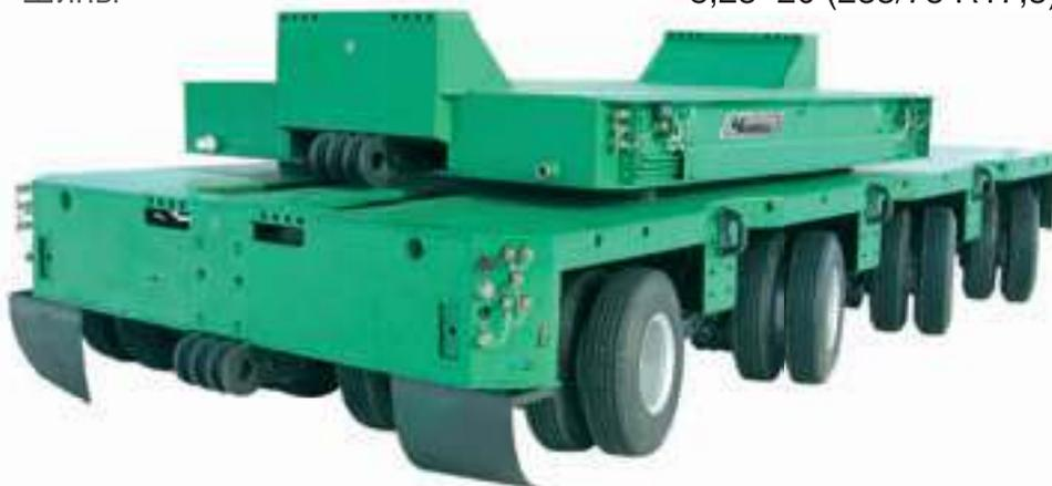
повышения плавности хода в гидросистеме подвесок подключены гидропневматические аккумуляторы, являющиеся упругим элементом подвески.
