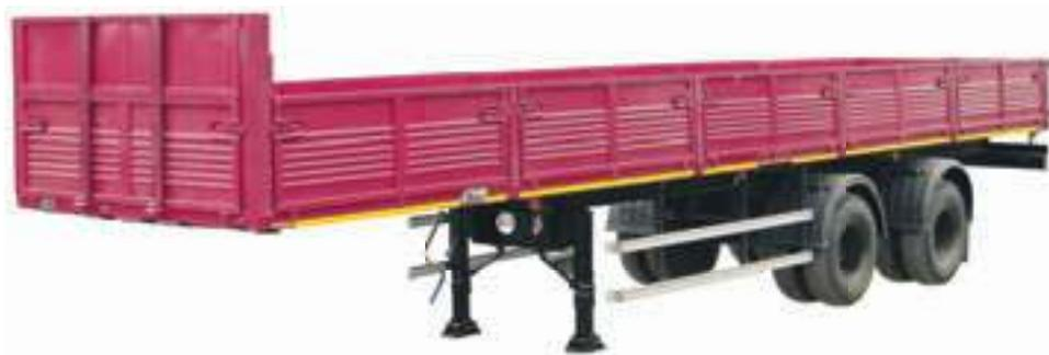
Предназначен для перевозки грузов в штучно-тарной упаковке. Обладает большим объемом кузова. Имеет откидные борта, обеспечивающие удобство при погрузке и разгрузке. Универсальность перевозимых гру-
