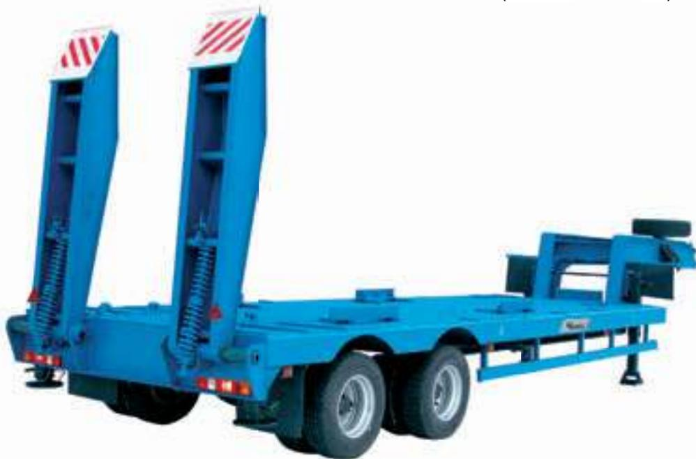
Данный полуприцеп оснащен трапами с пружинным помощником механизма подъема-опускания для въезда на плат-
