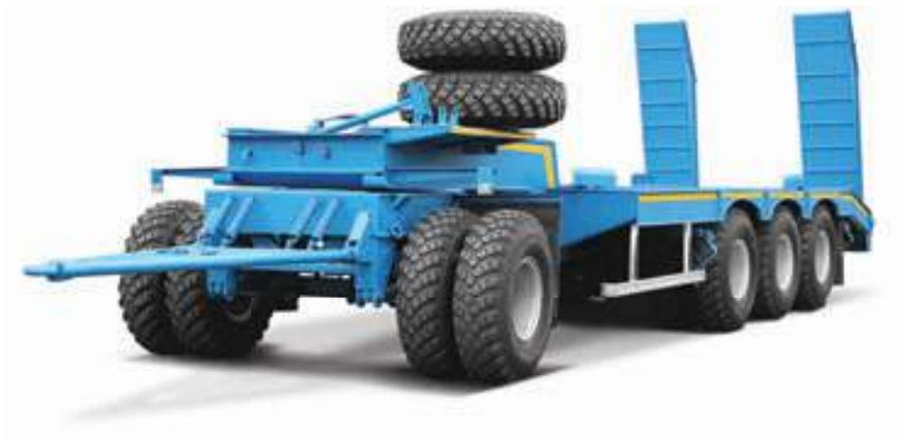
Предназначен для перевозки колесной и гусеничной техники, а также других нестандартных грузов по дорогам I–V технических категорий. Имеет четыре оси и состоит из двух основных частей: передней одноосной поворотной тележки с рессорной подвеской и опирающуюся на нее
