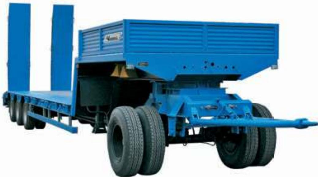
Прицеп предназначен для перевозки дорожно-строительной техники, колесно-гусеничных машин и крупногабаритных тяжеловесных неделимых грузов. Снаряжённая масса прицепа – 11 650 кг. Модель снабжена механическими трапами,
