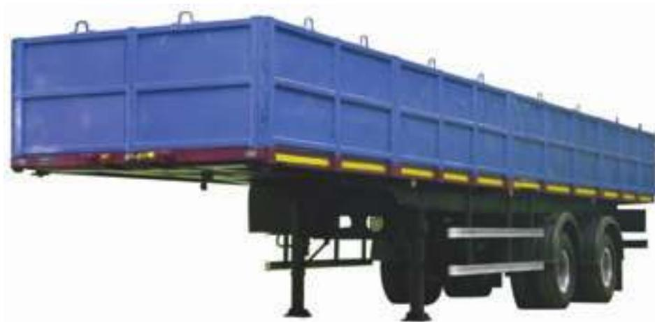
чика топливным баком, а так же контейнерными замками для перевозки контейнеров: 2 x 20 футов или 1 x 40 футов. Полуприцеп рассчитан на эксплуатацию при температуре окружающего воздуха от -45 С° до + 45 С° и
