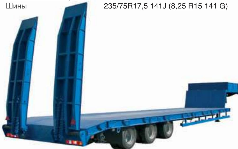
Предназначен для перевозки колёсной и гусеничной техники, а также нестандартных грузов собственной массой до 37,5 тонн. Снаряжённая масса полуприцепа составляет 12 тонн. Модель снабжена механическими трапами, оборудованными механическими помощниками подъё-
