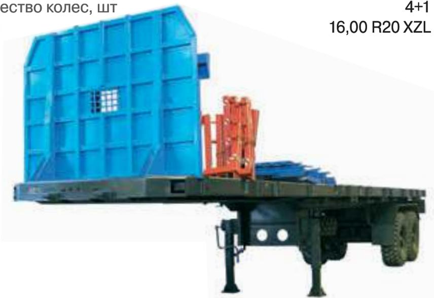
Предназначен для доставки оборудования для буровых скважин, других тяжелых, негабаритных и неделимых грузов для предприятий, осуществляющих разработку нефтяных и газовых месторождений. Конструкция позволяет перевозить различные грузы непосредственно со склада до нефтяных месторождений. Полуприцеп оснащен съемными бортами: боковы-
