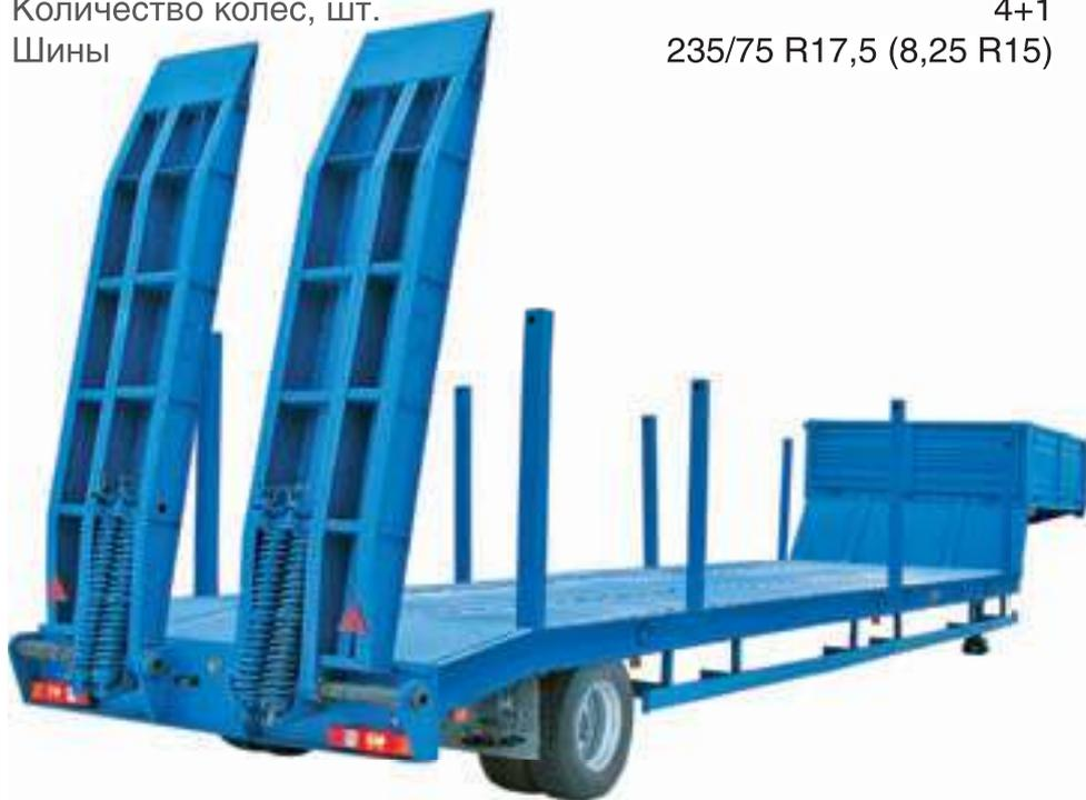
Полуприцепы с кониками с пониженной высотой грузовой платформы предназначены для перевозки длинномерных грузов.
