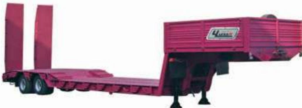
Предназначен для перевозки колёсной и гусеничной техники, а также нестандартных грузов собственной массой до 20 тонн. Модель ЧМЗАП-92853-000037-НШУ снабжена механическими трапами, оборудованными механическими помощниками подъема-опускания. Полуприцеп имеет сцепной шкворень
