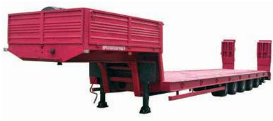
Полуприцеп-тяжеловоз предназначен для перевозки колёсной и гусеничной техники, а также нестандартных грузов. Модель снабжена механическими трапами, оборудованными механическими помощниками подъема и опускания, для въезда на погрузочную платформу своим ходом под углом 13°. По желанию заказчика модель может комплектоваться гид-
