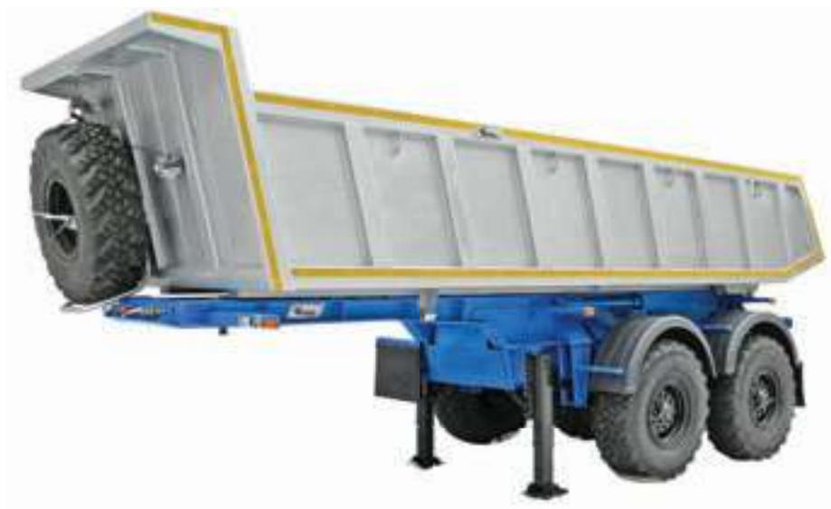
Полуприцеп-самосвал автомобильный ЧМЗАП-95201-0000040 с задним опрокидыванием кузова предназначен для перевозки сыпучих сельскохозяйственных грузов по дорогам I-III категории общей сети дорог. Тягачи должны быть доукомплектованы гидронасосом, масляным баком, распределителем и гидравлически-
