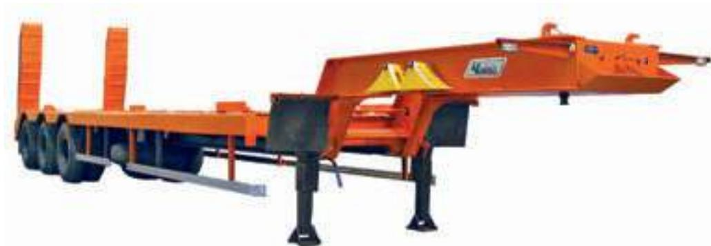
Полуприцеп-тяжеловоз ЧМЗАП-9906.40 0000-075 предназначен для перевозки строительного-дорожной техники, колесной и гусеничной техники и других тяжелых грузов по дорогам I, II и III технических категорий (СНиП 2.05.02-85). Оснащен механическими трапами. Подвеска 6-ти рессорная балансирующая. Имеются дополнительные опоры для заезда техники. Для обеспечения грузопо-
