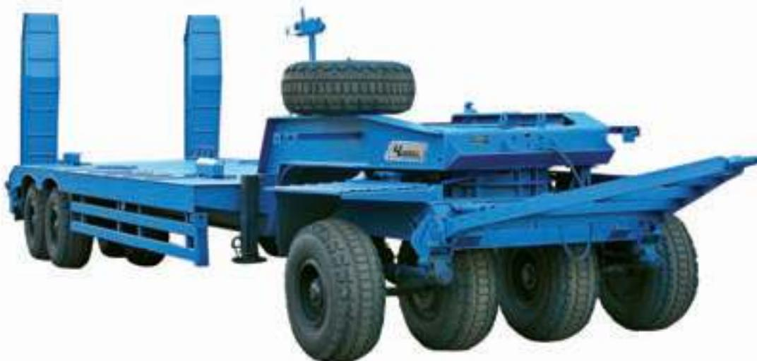
Автомобильный полуприцеп-тяжеловоз в сборе с подкатной тележкой (далее прицеп) предназначен для перевозки крупногабаритных неделимых грузов и колесной техники по I–V категории общей сети дорог. Прицеп рассчитан
