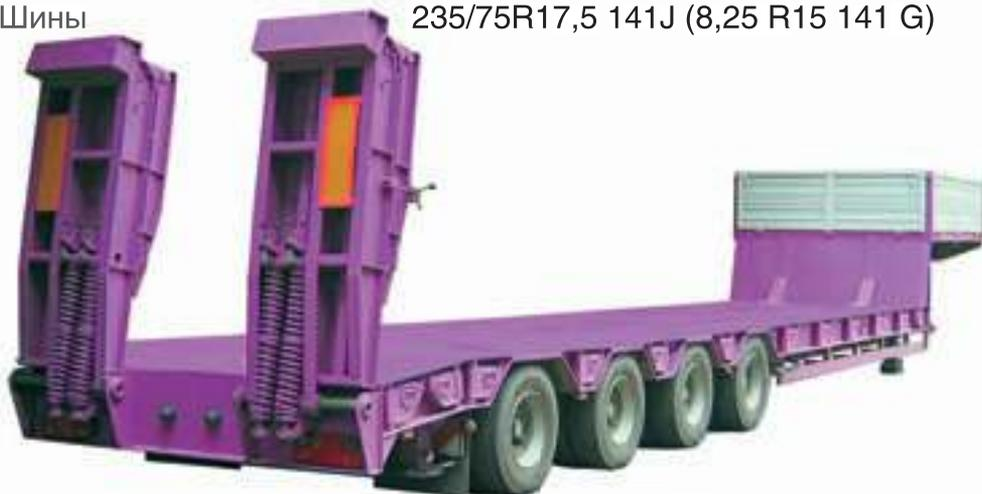
Полуприцеп-тяжеловоз предназначен для перевозки колёсной и гусеничной техники, а также нестандартных грузов собственной массой до 54 тонн.
