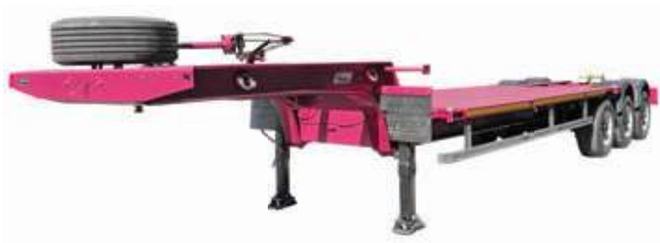
Полуприцеп-контейнеровоз ЧМЗАП 9911-061-П отличается повышенной грузоподъемностью и прочностью. Данная модель контейнеровоза идеально подходит для потребителей, имеющих потребность в перевозке 20-ти футовых танк-контейнеров. Грузоподъемность полупри-
