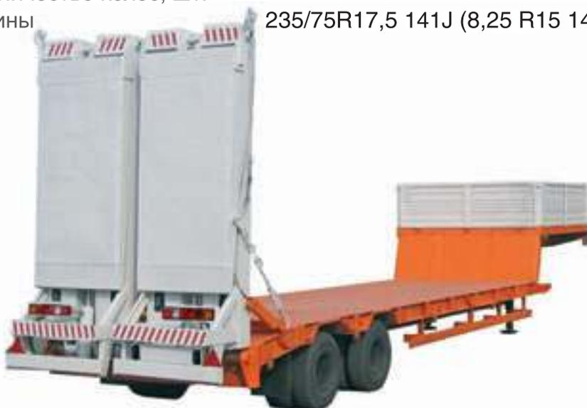
Полуприцепы предназначены для перевозки колёсной и гусеничной техники, а также нестандартных грузов. Снаряжённая масса полуприцепов – 8 т. Обе модели снабжены гидравлическими трапами для въезда на платформу своим ходом под углом 6° на первой ступени и 8° на второй ступени, при этом модель 029 оборудована гидравлической лебёдкой.
