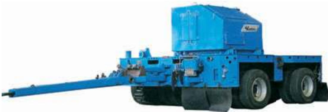
Модульные прицепы-тяжеловозы предназначены для перевозки нестандартных и негабаритных грузов с различной собственной массой (см. технические характеристики).
