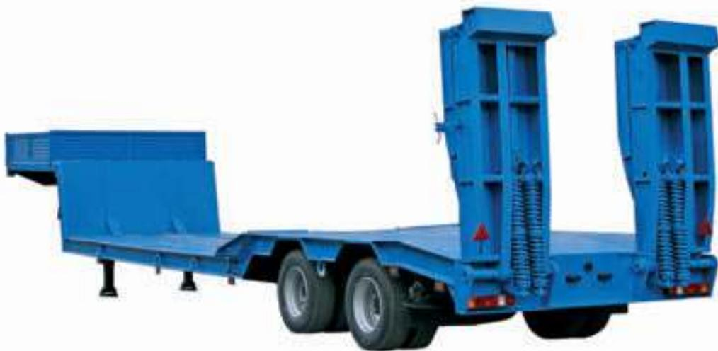
000037НРК рассчитана на сцепку с седельным тягачом колесной формулой 6×4 или 6×6. Дополнительное оборудование: уширители грузовой платформы, гидравлические трапы, подкатная тележка, замки для крепления контейнеров, антиблокировочная система тормозов. Расчитан на эксплуатацию по дорогам
