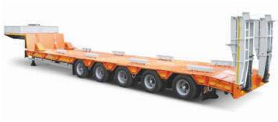
Полуприцеп-тяжеловоз предназначен для перевозки колёсной и гусеничной техники, а также нестандартных грузов. Модель снабжена механическими трапами, оборудованными механическими помощниками подъема и опускания, для въезда на погрузочную платформу своим ходом под углом 13°. По желанию заказчика модель может комплектоваться гидравлической лебедкой. Стандартная ширина
