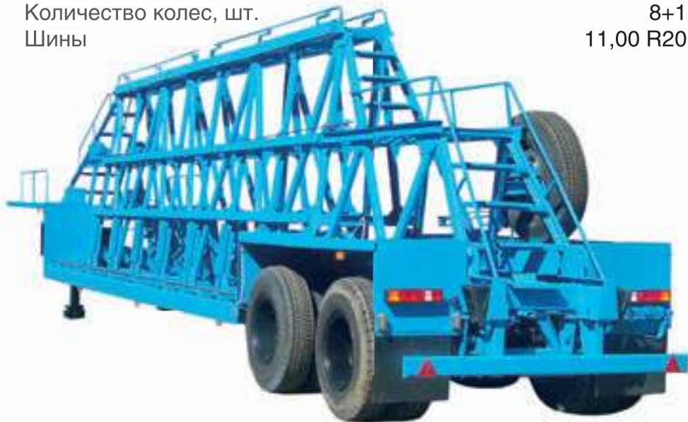
Снаряженная масса полуприцепа – 10 т. Длина загрузочного пространства платформы 8,32 м. Максимальная скорость движения полуприцепа полной массы 90 км/ч. Крепление панелей осуществляется между собой цепями, вставляемыми в проушины панелей. Для увеличения устойчивости перевозимых панелей оснащены страховочными тросами, натяжение которых осуществляется с помощью ручных
