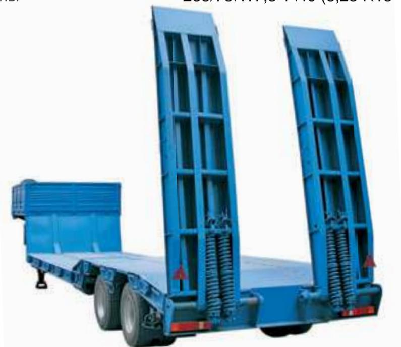
Полуприцеп ЧМЗАП-93853-0000037-НРК предназначен для перевозки колёсной и гусеничной техники, а также других нестандартных грузов. Модель
