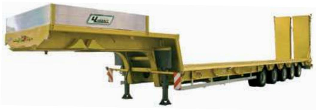
Полуприцеп предназначен для перевозки колёсной и гусеничной техники, а также нестандартных грузов. 4, 5 оси – самоустанавливающиеся. Снаряженная масса полуприцепа – 18 500 кг. На полуприцепе установлены гидравлические трапы шириной 1 050 мм. Угол въезда по ним 6° и 8°. По желанию заказчика модель может комплектоваться гидрав-
