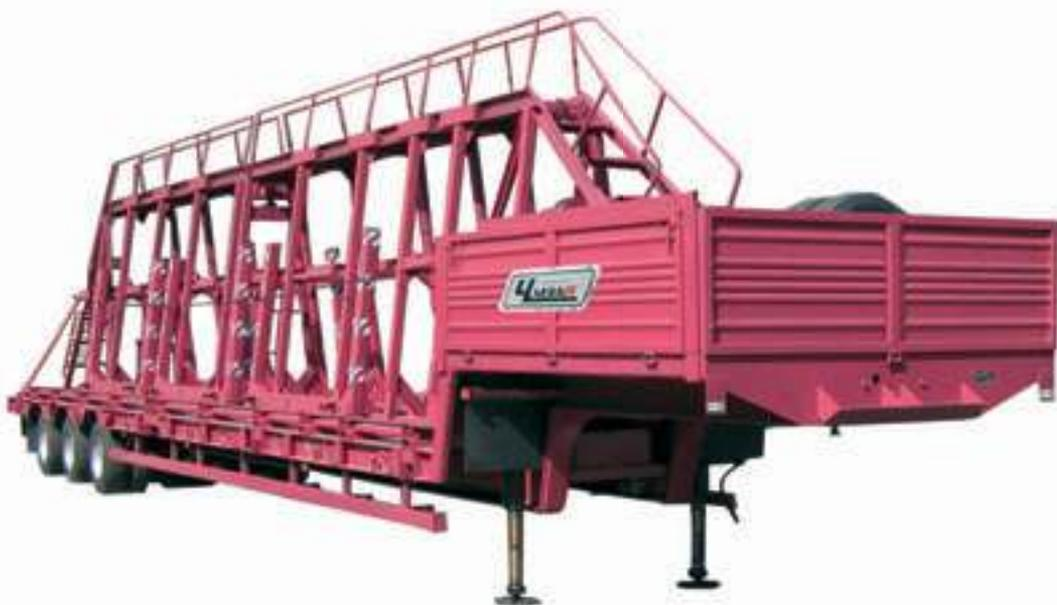
столбы и т.п.) для этого полуприцеп комплектуется стойками-кониками; большегрузные контейнеры 20 и 40 футов благодаря наличию замков для крепления контейнеров; железобетонные конструк-
