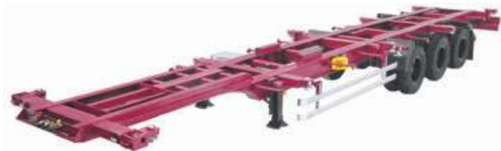
Полуприцепы-контейнеровозы оснащены шестью парами замков для контейнеров, что позволяет перевозить один или два контейнера. По одному контейнеру типов 1А, 1АА (сорокафутовому) или по одному контейнеру типов 1В, 1ВВ (тридцатифутовому) или по два контейнера типов 1С, 1СС (двадцатифутовых).
