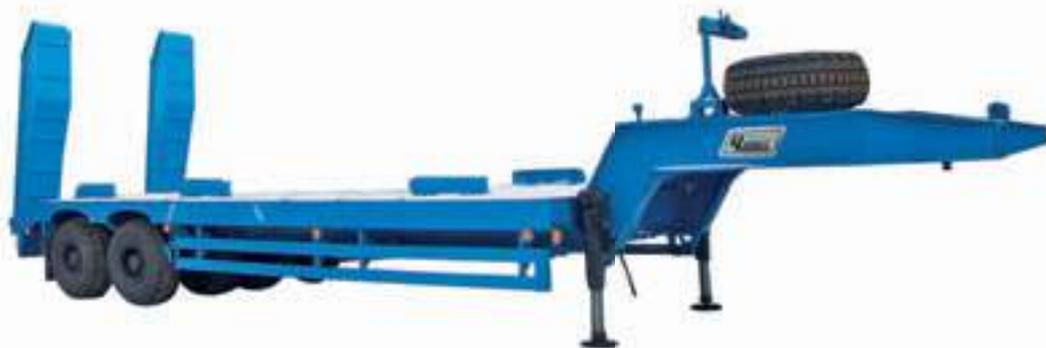
Полуприцеп-тяжеловоз предназначен для перевозки колесной и гусеничной техники, а также других нестандартных грузов по дорогам I–V технических категорий. Сцепной шкворень 50,8 мм (2 дюйма). Прицеп предназначен для эксплуатации с грузовыми автомобилями, имеющими тягово-сцепное устройство. Подвеска балансирующая. Дополнительное оборудование: отбойные бруссы, трапы с механизмом подъема, направляющий ролик, дополнительные опоры,
