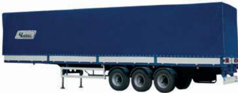
Полуприцеп предназначен для перевозки пакетированных грузов, уложенных и упакованных на стандартных поддонах. Размеры полуприцепа обеспечивают вместимость в разрешённые для автопоезда габариты. Полезный объём тентованного пространства 89 кубометров. Конструкция каркаса тента позволяет дополнительно увеличивать высоту крыши до 300 миллиметров. По краям пола грузовой платформы имеются вынимающи-
