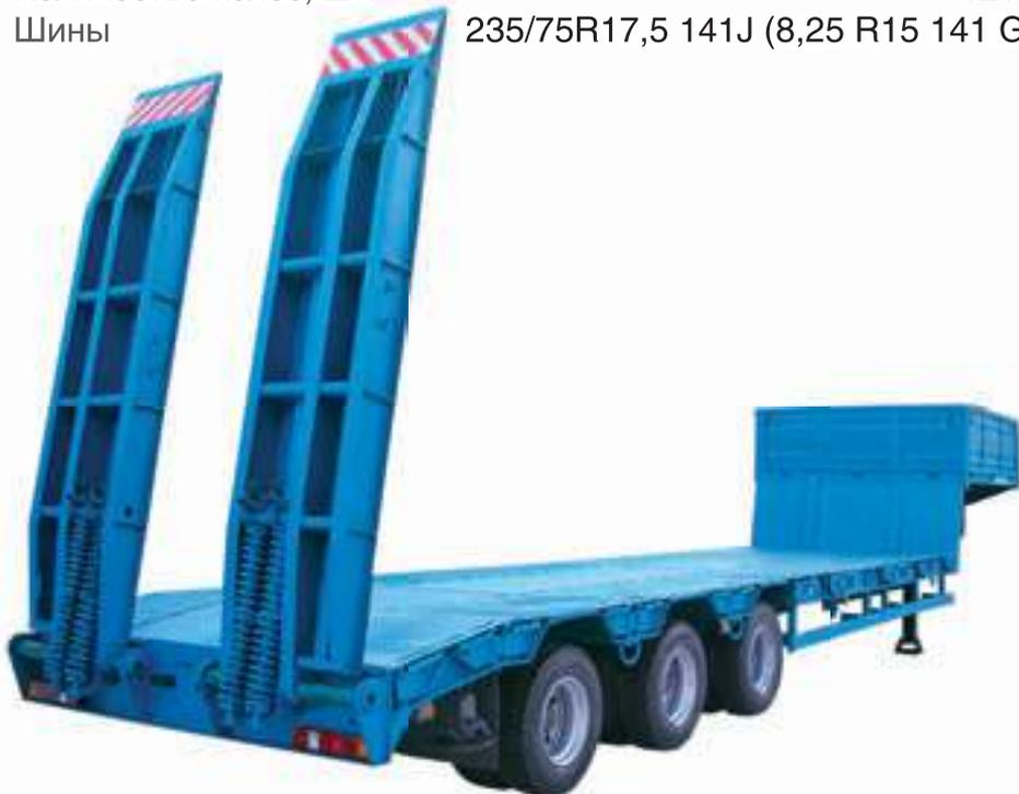
Полуприцеп предназначен для перевозки колесной и гусеничной техники и нестандартных грузов. Основными потребителями являются дорожно-строитель-
