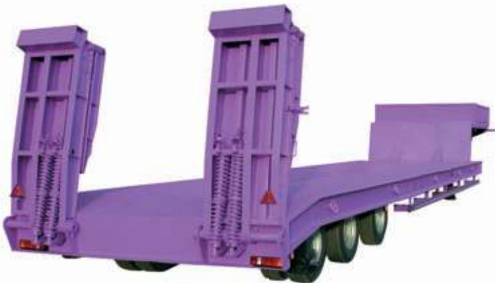
Полуприцеп предназначен для перевозки колёсной и гусеничной техники, а также крупногабаритных неделимых грузов. Для обеспечения грузоподъемности 45 тонн, полуприцеп снабжен рамой с усиленными лонжеронами. Снаряжённая масса полуприцепа составляет 13,5 тонн. Модель
