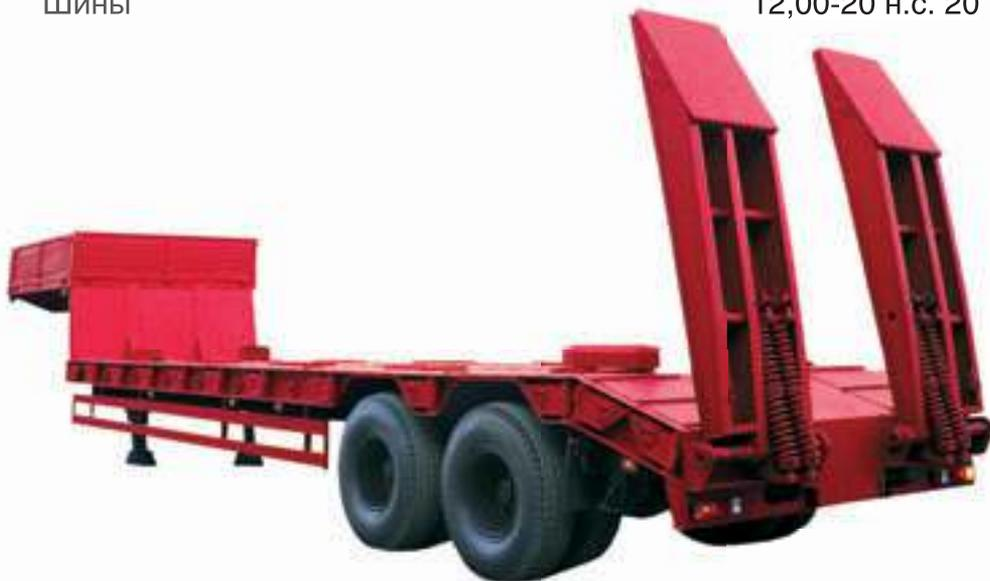
Полуприцеп-тяжеловоз предназначен для перевозки колесной и гусеничной техники, а также других нестандартных грузов по дорогам I–V технических категорий. Оснащен трапами с механическим помощником подъема-опускания, угол въезда по трапам 18 градусов. Снаряженная масса полуприцепа – 13 тонн.
