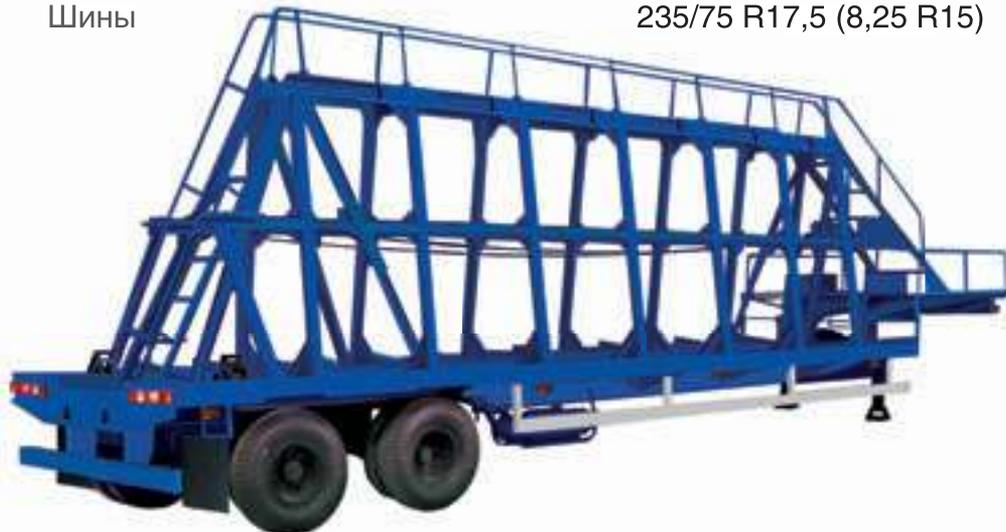
Предназначен для перевозки стеновых железобетонных панелей в гражданском и промышленном строительстве. Снаряженная масса 6 т. Длина загрузочного пространства платформы 8 метров. Тормозные механизмы колодочные барабанного типа с двухпроводным пневматическим приводом и кулачковым разжимным колодок. Ширина коридора, занимаемого автопоездом при повороте тягача с наружным габаритным радиусом 15,5 метров, не
