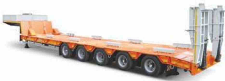
Полуприцеп-тяжеловоз предназначен для перевозки колёсной и гусеничной техники, а также нестандартных грузов. Модель снабжена механическими трапами, оборудованными механическими помощниками подъема и опускания, для въезда на погрузочную платформу своим ходом под углом 13°. По желанию заказчика модель может комплектоваться гидравлической лебедкой. Стандартная ширина
