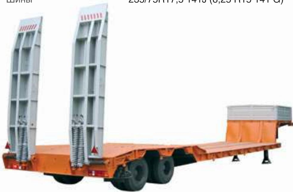
Особенностью полуприцепа ЧМЗАП-93853-0000037НР в том, что он имеет две грузовые платформы: низкорамную высотой 630 мм и платформу над колесами 885 мм, что является преимуществом
