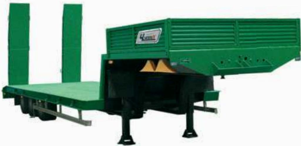
Полуприцеп-тяжеловоз с пониженной высотой грузовой платформы ЧМЗАП-9906.400000.052-МТШ отличается от базовой модели ЧМЗАП-9906.400000.052-МТ2 шириной платформы, которая составляет 3 150 мм. Полуприцеп рассчитан на эксплуатацию по дорогам I-III
