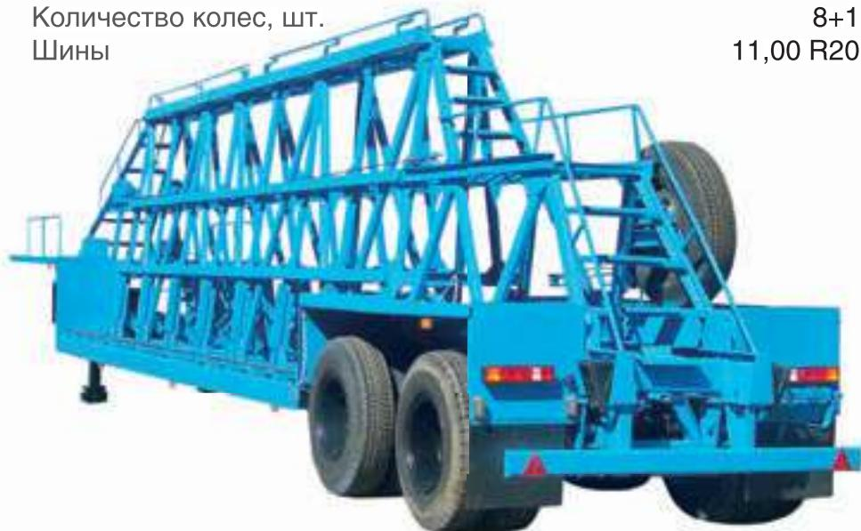
Снаряженная масса полуприцепа – 10 т. Длина загрузочного пространства платформы 8,32 м. Максимальная скорость движение полуприцепа полной массы 90 км/ч. Крепление панелей осуществляется между собой цепями, вставляемыми в проушины панелей. Для увеличения устойчивости перевозимых панелей оснащен страховочными тросами, натяжение которых осуществляется с помощью ручных
