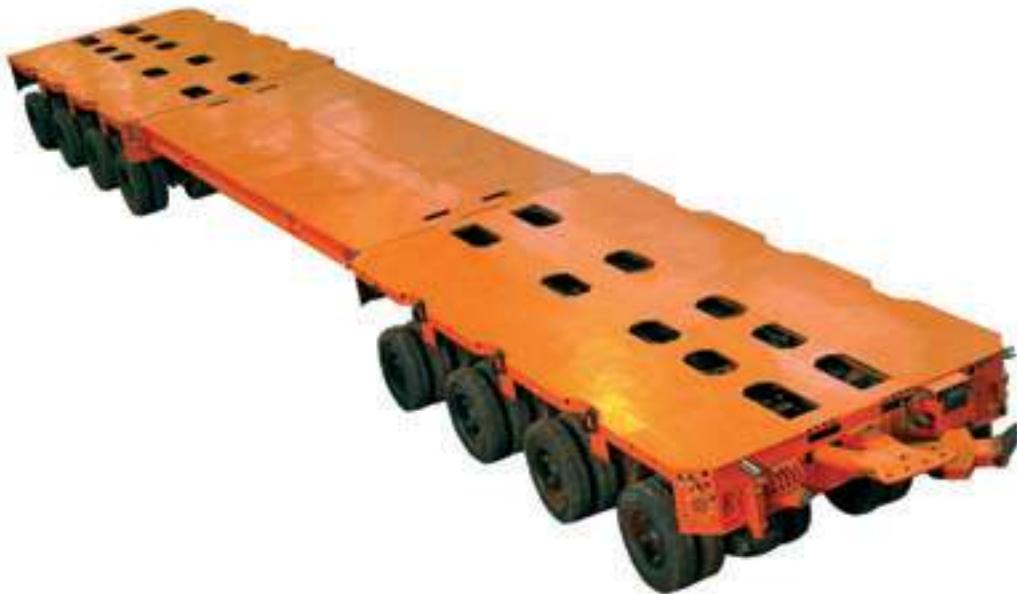
ход подвески обеспечивает преодоление значительных по высоте макро- и микронеровностей дороги, сохраняя при этом равномерное распределение нагрузки между осями, и, кроме того, гидроцилиндры подвески могут быть использованы как домкраты для подъема-опускания
