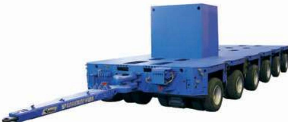
тво которых зависит от полной массы прицепного звена и тяговых свойств тягачей, масса балласта 12–15 тонн. В кузове или на грузовой платформе тягача устанавливается гидравлическая силовая установка, необходимая для подачи жидкости в гидроцилиндры подвески при подъеме грузовой платформы транспортного средства или в гидроцилиндры руля при управлении поворотом транспортного средства от ручного пульта оператора. Тягач должен иметь пневмо- и электровы-
