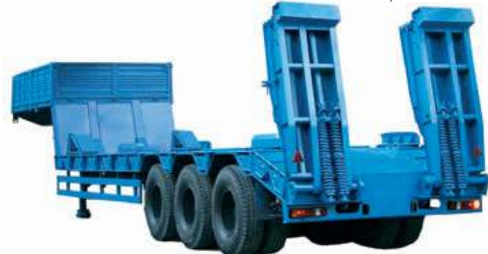
Полуприцеп-тяжеловоз предназначен для перевозки колесной и гусеничной техники, а также других нестандартных грузов в подорожам I–V технических категорий. Стандартная ширина платформы 2,5 м, но с помощью боковых уширителей возможно увеличение погрузочной ширины до 3,15 м. Модель снабжена механическими трапами шириной 700 мм, оборудованными механическими помощниками подъ-
