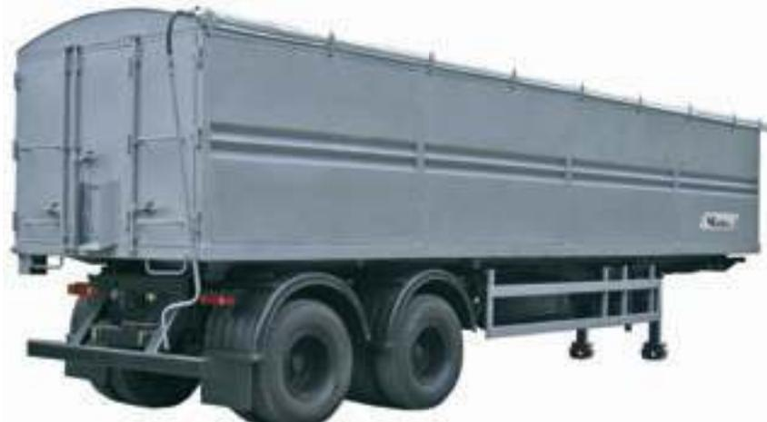
Полуприцеп-самосвал ЧМЗАП-95201-0000050 предназначен для перевозки сельско-хозяйственных сыпучих грузов по дорогам I, II, III категорий.
