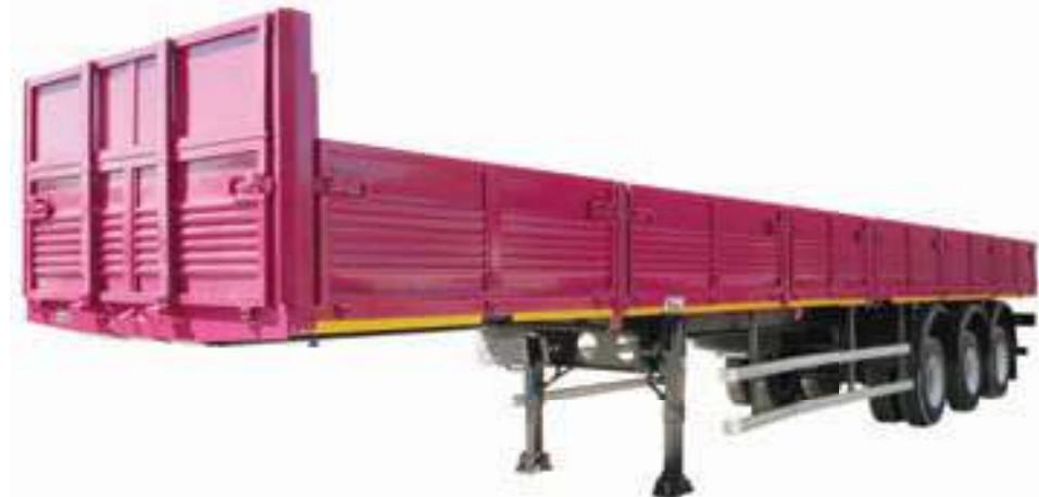
Бортовой полуприцеп ЧМЗАП 99065-031-ПГ1 отличается повышенной грузоподъемностью – он способен перевозить до 40 тонн груза. Также у бортового полуприцепа ЧМЗАП 99065-031-ПГ1 увеличена длина до 14360 мм, за счет чего он
