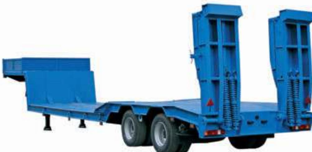
0000037HPK рассчитана на сцепку с седельным тягачом колесной формулой 6×4 или 6×6. Дополнительное оборудование: уширители грузовой платформы, гидравлические трапы, подкатная тележка, замки для крепления контейнеров, антиблокировочная система тормозов. Расчитан на эксплуатацию по дорогам
