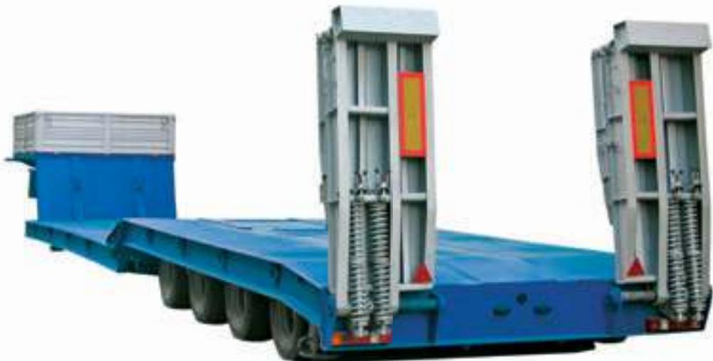
Полуприцеп-тяжеловоз предназначен для перевозки негабаритных по высоте грузов, тяжелой дорожно-строительной и гусеничной техники. 3, 4 оси – самоустанавливающиеся. Подвеска пневматическая ВРВ. Имеет собственно две грузовые платформы: низкорамную высотой 600 мм и платформу над колесами – 920 мм. На полуприцепе установлены двух-
