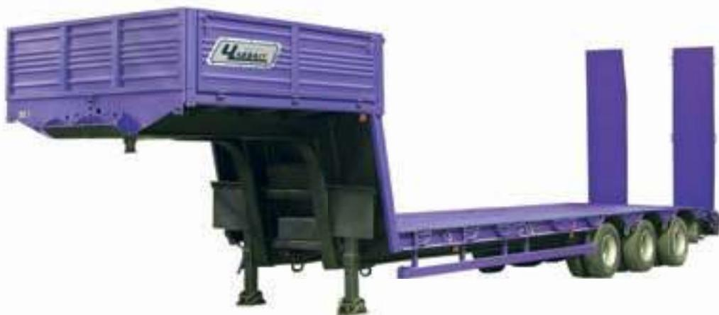
Полуприцеп-тяжеловоз предназначен для перевозки колёсной и гусеничной техники, а также нестандартных грузов. Снаряженная масса 10 тонн. Модель снабжена механическими трапами, оборудованными механическими помощниками подъема и опускания, для въезда на погрузочную платформу своим ходом под углом 13°. Стандартная ширина плат-
