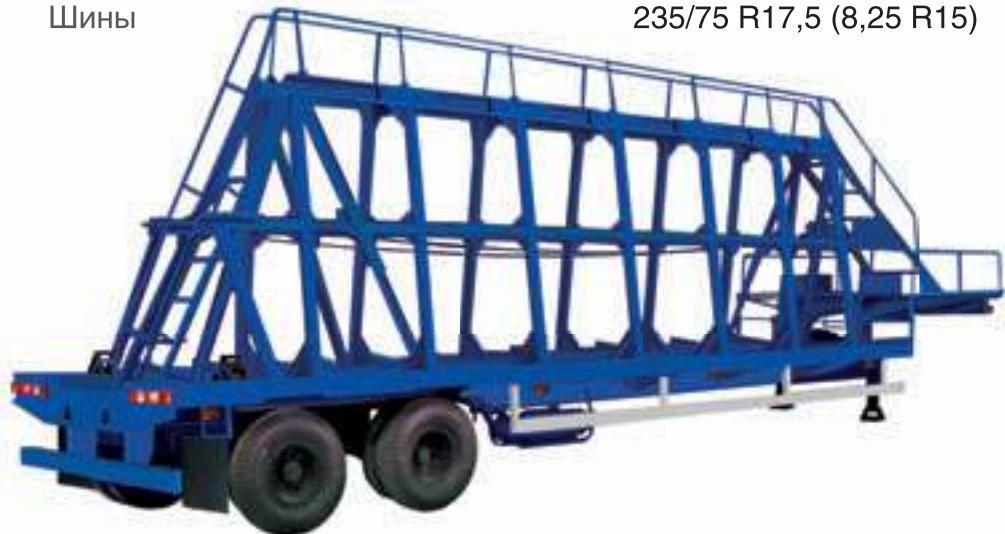
Предназначен для перевозки стеновых железобетонных панелей в гражданском и промышленном строительстве. Снаряженная масса 6 т. Длина загрузочного пространства платформы 8 метров. Тормозные механизмы колодочные барабанного типа с двухпроводным пневматическим приводом и кулачковым разжимом колодок. Ширина коридора, занимаемого автопоездом при повороте тягача с наружным габаритным радиусом 15,5 метров, не
