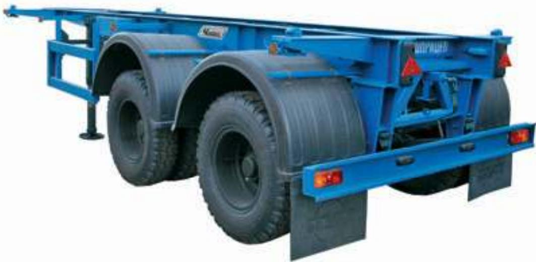
Полуприцепы-контейнеровозы предназначены для перевозки грузов в большегрузных контейнерах по ГОСТ 18477, а также цистерн-контейнеров. Контейнеровозы позволяют перевозить грузы различными видами транс-
