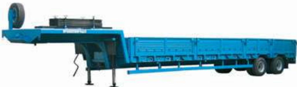
Прицеп предназначен для перевозки дорожно-строительной техники, колесно-гусеничных машин и крупногабаритных тяжеловесных неделимых грузов. Снаряженная масса полуприцепа 7,9 тонн. На грузовой платформе полуприцепа установлены съемные борта и стойки. Диаметр сцепного шкворня 2 дюйма (50,8
