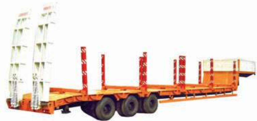
КМТ имеет собственный вес с кониками – 13 тонн. Полуприцеп оснащен шестью парами замков для контейнеров, что позволяет перевозить два (один) контейнера типов 1С или 1 СС, одного контейнера типов 1А, 1АА. Полуприцеп оснащен двенадцатью кониками высотой 1 365
