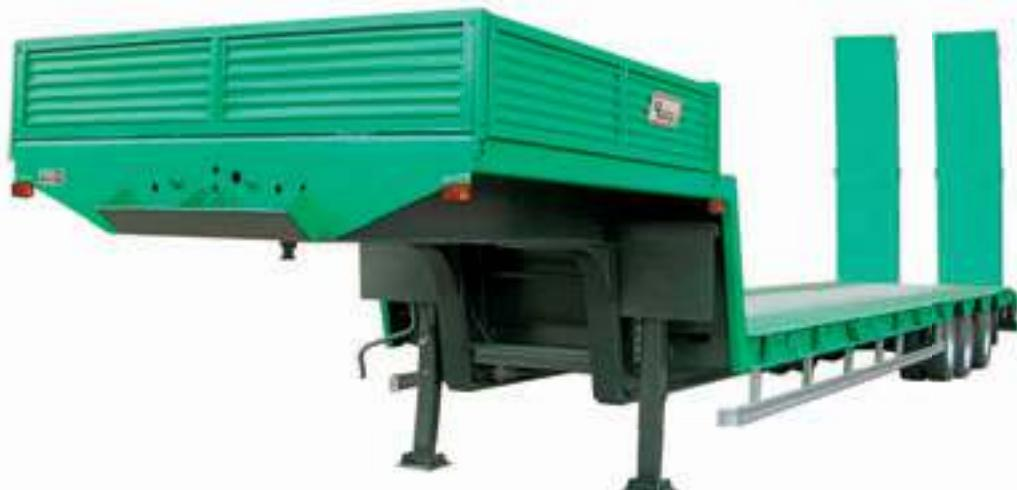
Предназначен для перевозки колёсной и гусеничной техники, а также нестандартных грузов собственной массой до 38 тонн. Снаряжённая масса полуприцепа составляет 11,5 т. Модель снабжена механическими трапами, оборудованными механическими помощниками подъёма-опускания, для въезда на платформу своим ходом. С помощью боковых уширителей возможно увеличение погрузочной
