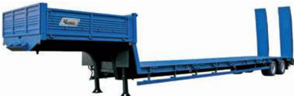
Полуприцеп-тяжеловоз с пониженной высотой грузовой платформы модели ЧМЗАП-93853-0000030-МТУ предназначен для перевозки колёсной и гусеничной техники, а также нестандартных грузов собственной массой до 24 тонн.
