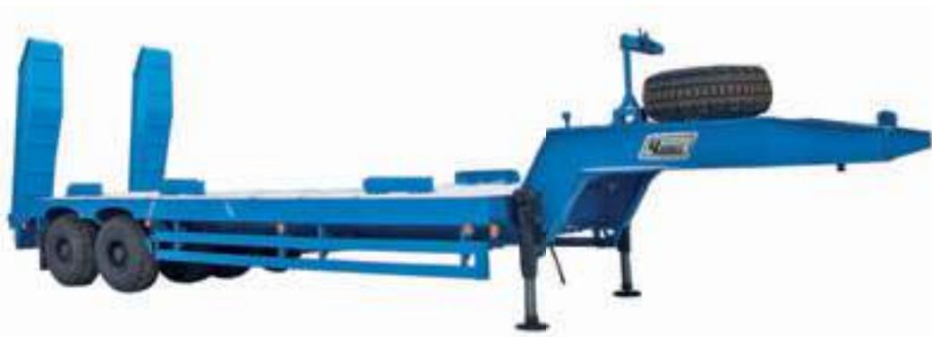
Полуприцеп-тяжеловоз предназначен для перевозки колесной и гусеничной техники, а также других нестандартных грузов по дорогам I–V технических категорий. Сцепной шкворень 50,8 мм (2 дюйма). Прицеп предназначен для эксплуатации с грузовыми автомобилями, имеющими тягово-сцепное устройство. Подвеска балансирная. Дополнительное оборудование: отбойные брусья, трапы с мезанизмом подъема, направляющий ролик, дополнительные опоры,
