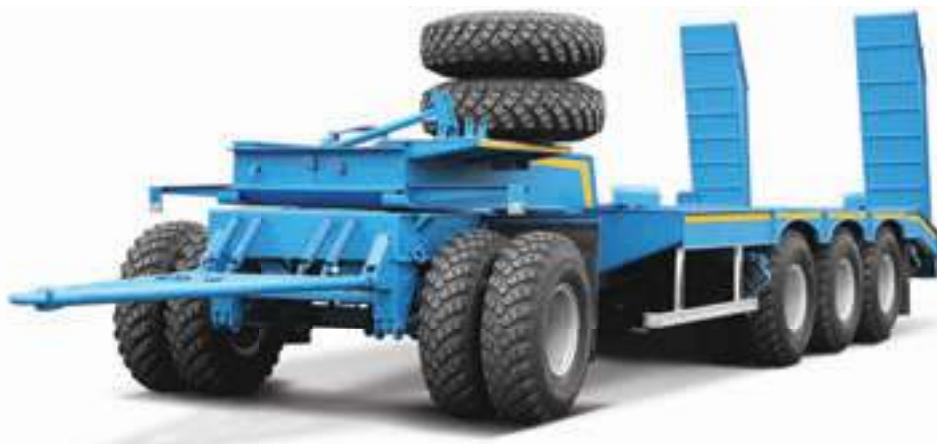
Предназначен для перевозки колесной и гусеничной техники, а также других нестандартных грузов по дорогам I-V технических категорий. Имеет четыре оси и состоит из двух основных частей: передней одноосной поворотной тележки с рессорной подвеской и опирающуюся на нее
