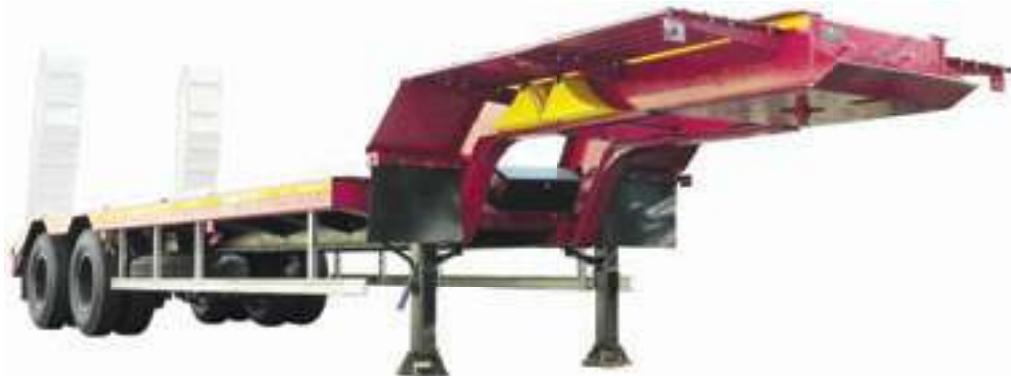
Полуприцеп предназначен для перевозки дорожно-строительной техники и других крупногабаритных неделимых грузов. 4-х рессорная балансирная подвеска, с рессорой под осью. На полуприцепе установлены механические трапы шириной 450
