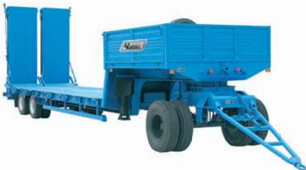
Прицеп предназначен для перевозки дорожно-строительной техники, колесно-гусеничных машин и крупногабаритных тяжеловесных неделимых грузов. Снажённая масса прицепа – 9 650 кг. Снажена гидравлическими трапами для въезда на платформу своим ходом под углом 6° на первой ступени и 8° на второй ступе-
