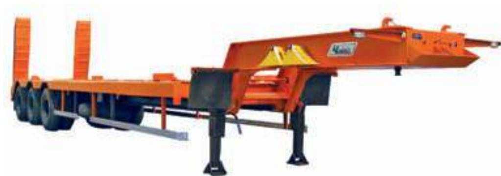
Полуприцеп-тяжеловоз ЧМЗАП-9906.40 0000-075 предназначен для перевозки строительно-дорожной техники, колесной и гусеничной техники и других тяжеловесных грузов по дорогам I, II и III-технических категорий (СНиП 2.05.02-85). Оснащен механическими трапами. Подвеска 6-ти рессорная балансирная. Имеются дополнительные опоры для заезда техники. Для обеспечения грузопо-
