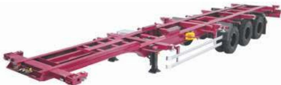
Полуприцепы-контейнеровозы оснащены шестью парами замков для контейнеров, что позволяет перевозить один или два контейнера. По одному контейнеру типов 1A, 1AA (сорокифутовому) или по одному контейнеру типов 1B, 1BB (тридцатифутовому) или по два контейнера типов 1C, 1CC (двадцатифутовых).
