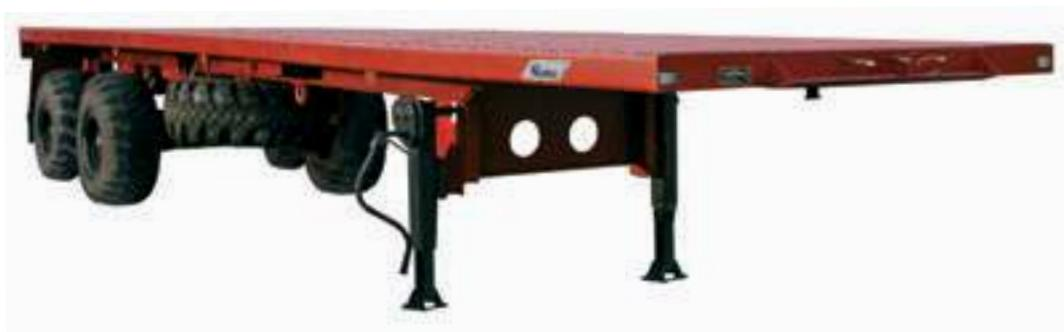
Полуприцеп шасси ЧМЗАП-9907.2-040 предназначен для монтажа специальных кузовов фургонов и различных установок, в том числе и емкостей для различных жидкостей. Масса снаряженного полуприцепа 5 тонн. Полезная площадь пола платформы 24 кв.м. Подвеска зависимая рессорная.
