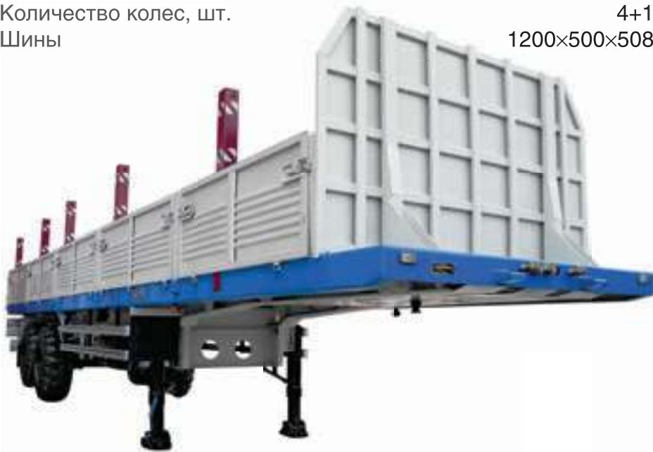
Предназначен для перевозки грузов в штучно-товарной упаковке, а благодаря раздвижным коникам — длинномерных грузов. Борта откидные, обеспечивающие удобство при погрузке и разгрузке. Сцепной шкворень 2 дюйма. Максимальная масса снаряженного полуприцепа — 7 тонн.
