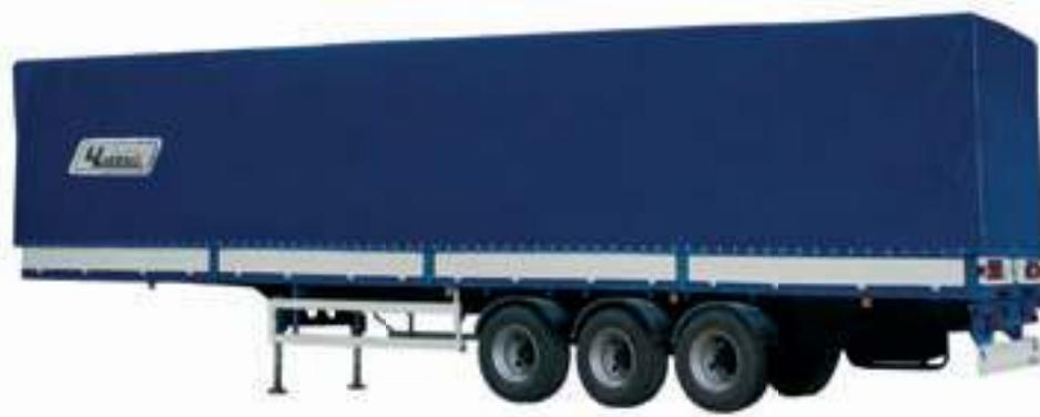
Полуприцеп предназначен для перевозки пакетированных грузов, уложенных и упакованных на стандартных поддонах. Размеры полуприцепа обеспечивают вместимость в разрешённые для автопоезда габариты. Полезный объём тентованного пространства 89 кубометров. Конструкция каркаса тента позволяет дополнитель но увеличивать высоту крыши до 300 миллиметров. По краям пола грузовой платформы имеются вынимающи-
