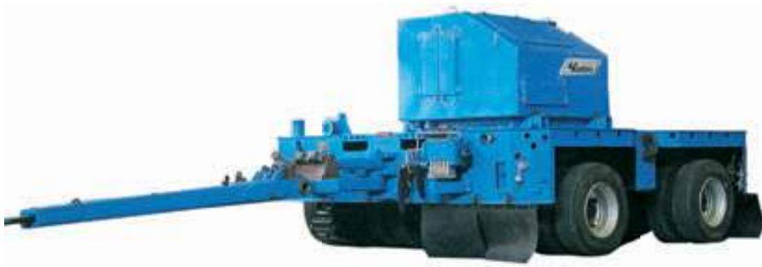
Модульные прицепы-тяжеловозы предназначены для перевозки нестандартных и негабаритных грузов с различной собственной массой (см. технические характеристики).
