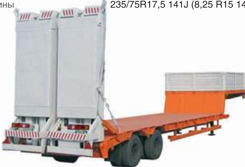
Полуприцепы предназначены для перевозки колёсной и гусеничной техники, а также нестандартных грузов. Снаряжённая масса полуприцепов – 8 т. Обе модели снабжены гидравлическими трапами для въезда на платформу своим ходом под углом 6° на первой ступени и 8° на второй ступени, при этом модель 029 оборудована гидравлической лебёд-
