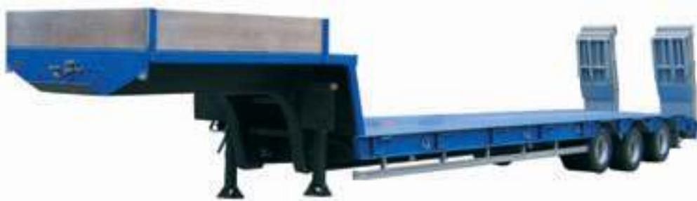
Полуприцеп-тяжеловоз с пониженной высотой грузовой платформы модели ЧМЗАП-9906.400000.052G45 предназначен для перевозки колёсной и гусеничной техники, а также нестандартных грузов собственной массой до 45 тонн.
