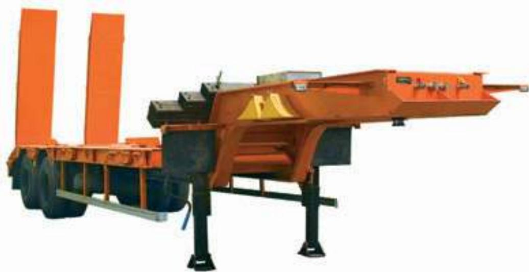
Полуприцеп-тяжеловоз предназначен для перевозки колёсной и гусеничной техники, а также других нестандартных грузов по дорогам I–V технических категорий. Модель снабжена механическими трапами, шириной 750 мм с механическими помощниками подъёма и опускания,
