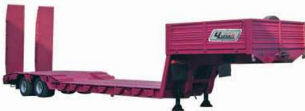
Предназначен для перевозки колёсной и гусеничной техники, а также нестандартных грузов собственной массой до 20 тонн. Модель ЧМЗАП-92853-0000037-НШУ снабжена механическими трапами, оборудованными механическими помощниками подъёма-опускания. Полуприцеп имеет сцепной шкворень
