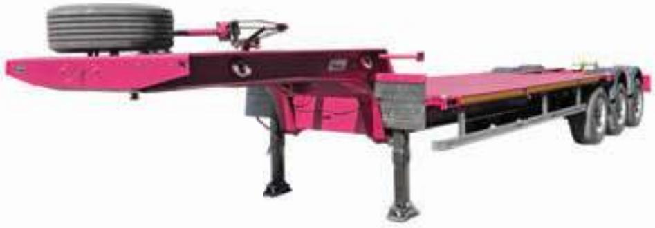
Полуприцеп-контейнеровоз ЧМЗАП 9911-061-П отличается повышенной грузоподъемностью и прочностью. Данная модель контейнеровоза идеально подходит для потребителей, имеющих потребность в перевозке 20-ти футовых танк-контейнеров. Грузоподъемность полупри-
