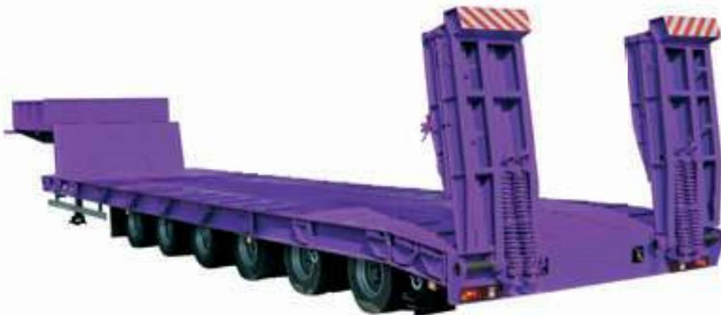
Предназначен для перевозки колесной и гусеничной техники, а также нестандартных грузов. Снаряженная масса полуприцепа составляет 19 тонн. Модель снабжена механическими, двухступенчатыми трапами, оборудованными механическими помощниками подъема-опускания, для въезда на платформу техники своим ходом, под углом 13°. По желанию заказчика модель может комплектоваться гидравлической лебедкой. С помощью
