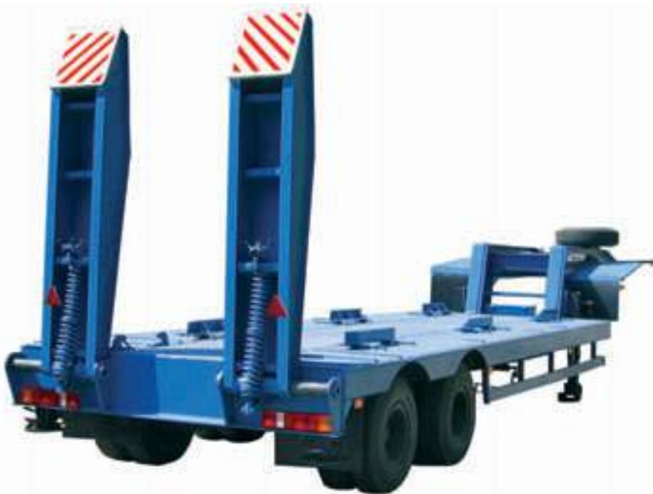
Полуприцеп предназначен для перевозки дорожно-строительной техники, колесно-гусеничных машин и крупнога-
