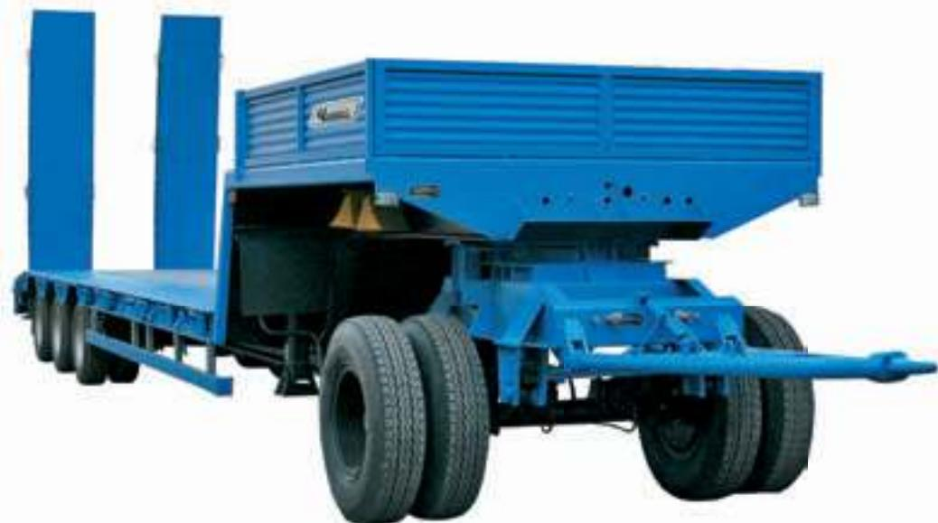
Прицеп предназначен для перевозки дорожно-строительной техники, колесно-гусеничных машин и крупногабаритных тяжеловесных неделимых грузов. Снаряженная масса прицепа – 11 650 кг. Модель снабжена механическими трапами,
