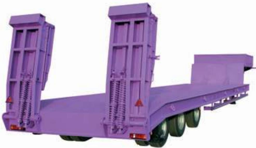
Полуприцеп предназначен для перевозки колёсной и гусеничной техники, а также крупногабаритных неделимых грузов. Для обеспечения грузоподъёмности 45 тонн, полуприцеп снабжен рамой с усиленными лонжеронами. Снаряженная масса полуприцепа составляет 13,5 тонн. Модель
