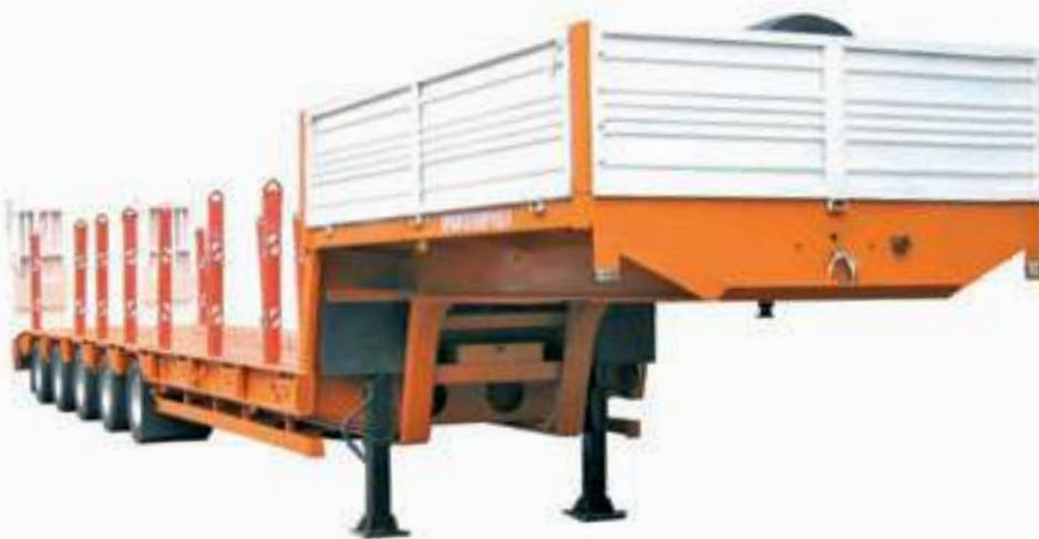
при перевозке крупногабаритных грузов полуприцеп обустроен уширителями рамы. Для перевозки длинномерных грузов полуприцеп оборудован съемными стойками-кониками, которые вставляются в гнезда рамы.
