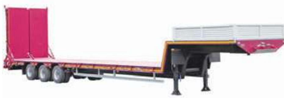
Полуприцеп-тяжеловоз с пониженной высотой грузовой платформы модели ЧМЗАП-9906.400000.042-02 предназначен для перевозки колёсной и гусеничной техники, а также нестандартных грузов. Снаряжённая масса полуприцепа составляет 11,5 тонн. Модель снабжена гидравлическими трапами для въезда на платформу своим ходом под углом 6° и 8°. Гусачная часть рамы, оборудованная бор-
