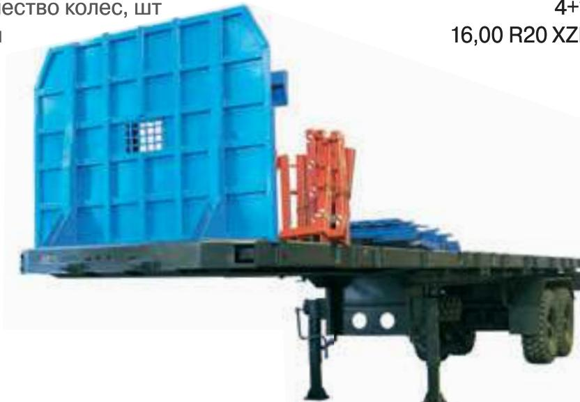
Предназначен для доставки оборудования для буровых скважин, других тяжелых, негабаритных и неделимых грузов для предприятий, осуществляющих разработку нефтяных и газовых месторождений. Конструкция позволяет перевозить различные грузы непосредственно со склада до нефтяных месторождений. Полуприцеп оснащен съемными бортами: боковы-
