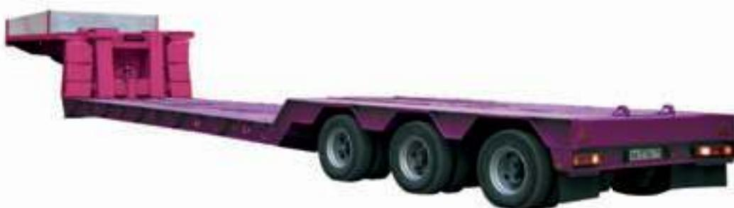
Полуприцеп-тяжеловоз низкорамный с отсоединяемым гусаком ЧМЗАП-93371-0000020 предназначен для транспортировки гусеничной техники. Его грузоподъёмность — 50 тонн. Масса снаряженного полуприцепа — 16 тонн. Особенностью данного полуприцепа является то, что заезд техники осуществляется спереди после отстыковки гусачной части. Приемуществом
