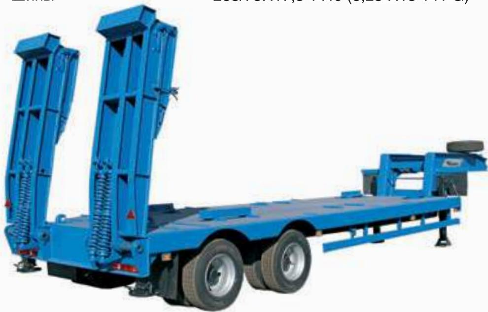
Автомобильный полуприцеп предназначен для перевозки крупногабаритных грузов и колесно-гусеничной техники по дорогам I–III технических категорий. Снаряженная масса полу-
