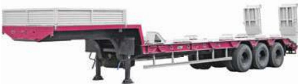
Полуприцеп-тяжеловоз предназначен для перевозки колесной и гусеничной дорожно-строительной техники, а также других нестандартных грузов по дорогам I–V технических категорий. Полная масса полуприцепа 75 тонн. Оснащен
