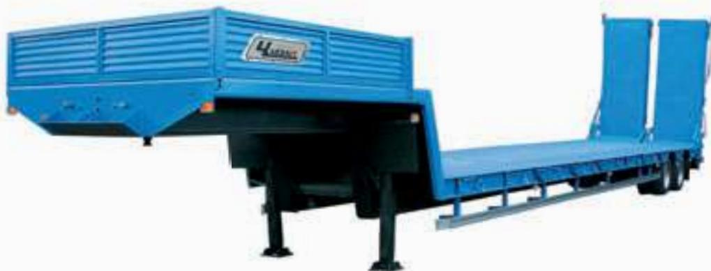
Полуприцеп предназначен для перевозки колесной и гусеничной техники и других тяжеловесных грузов по дорогам I, II, III технических категорий (СНиП 2.05.02-85). Подвеска рессорная. Модель снабжена гидравлическими трапами для въезда на платформу своим ходом под углом 6° на первой ступени и 8° на второй ступени и устройством
