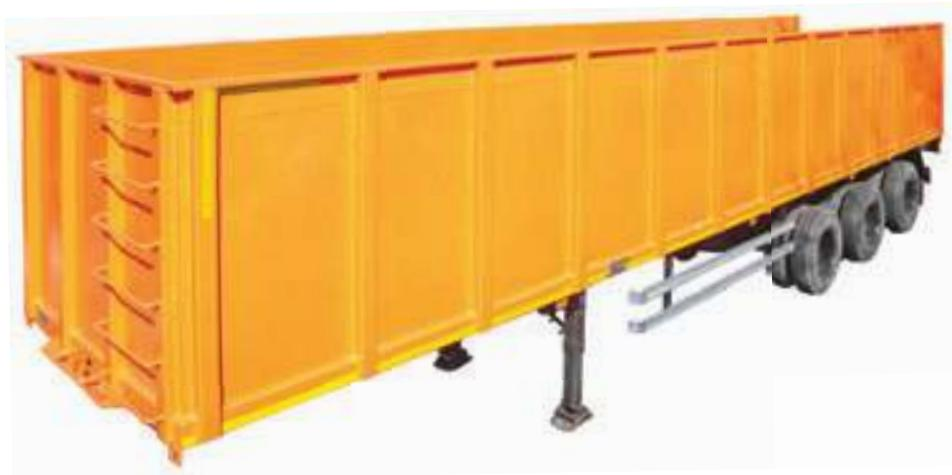
Бортовой полуприцеп 99065-033 идеально подходит для перевозки металлома. Он отличается повышенной объемом кузова. Высота боковых бортов
