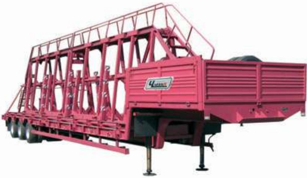
столбы и т.п.) для этого полуприцеп комплектуется стойками-кониками; большие грузные контейнеры 20 и 40 футов благодаря наличию замков для крепления контейнеров; железобетонные конструк-
