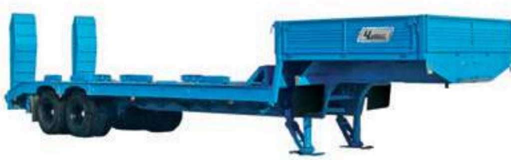
Полуприцеп-тяжеловоз предназначен для перевозки колесной и гусеничной техники, а также других нестандартных грузов по дорогам I–V технических категорий. Оснащен трапами с механическим помощником подъема-опускания, угол въезда по трапам 18 градусов. Снаряженная масса полуприцепа – 15 тонн. Сцепной шкворень 90 мм (3,5 дюйма). Может быть установлен шкворень диаметром 50,8 мм (2 дюйма), при этом полная масса
