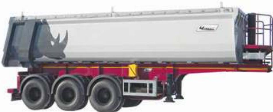
На «Носорогах» установлен телескопический гидроцилиндр фирмы PENTA с гидроклапаном защиты и двухпроводная пневматическая тормозная система.
