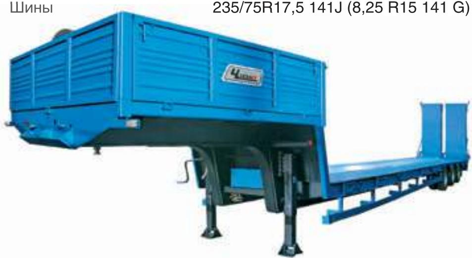
Полуприцеп-тяжеловоз предназначен для перевозки колёсной и гусеничной техники, а также нестандартных грузов. Снаряженная масса 10 тонн. Модель снабжена гидравлическими трапами, для въезда на погрузочную платформу своим ходом. Стандартная ширина платформы 2,5 метра, но с помощью боковых уширителей возможно увеличение погрузочной
