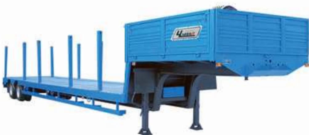
конфигурации 2S/2M. Масса снаряженного полуприцепа – 8,5 тонны. Трапы шириной 700 мм, имеют пружинный помощник подъема-опускания и устройство поперечного перемещения, которое дает возможность приспособить колею трапов под колею перевозимой техники. Допускается перевозка колесно-гусе-
