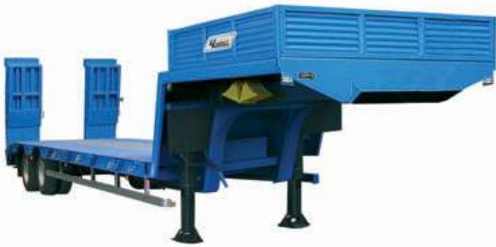
Полуприцеп предназначен для перевозки дорожно-строительной техники, колесно-гусеничных машин и крупногабаритных тяжеловесных неделимых грузов. Снаряженная масса полуприцепа – 8 т. Снабжен двухступенчатыми трапами с пружинным помощником механизма подъема-опускания для въезда на
