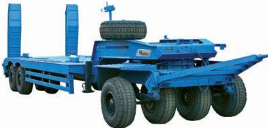
Автомобильный полуприцеп-тяжеловоз в сборе с подкатной тележкой (далее прицеп) предназначен для перевозки крупногабаритных неделимых грузов и колесной техники по I-V категориям общей сети дорог. Прицеп рассчи-
