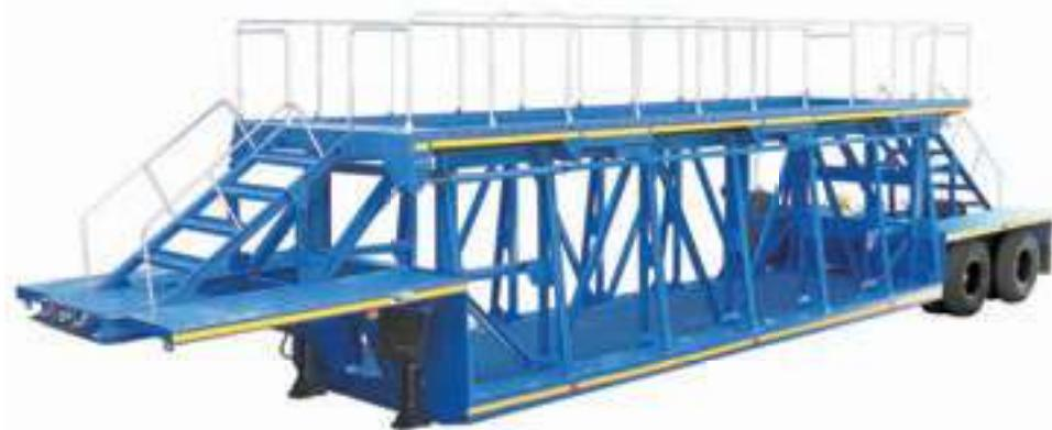
В конструкции этого полуприцепа-панелевоза кассетного типа предусмотрена максимально низкая погрузочная высота, для перевозки панелей размером более 3-х метров. Грузовая площадка рассчитана на короткие, но высокие панели, рядом с которыми можно дополнительно разместить другие стройматериалы. Полуприцеп-панелевоз кассетного типа ЧМЗАП-938532-0000020 является универсальным. На нем можно перевозить четное и нечетное число панелей, а также другие
