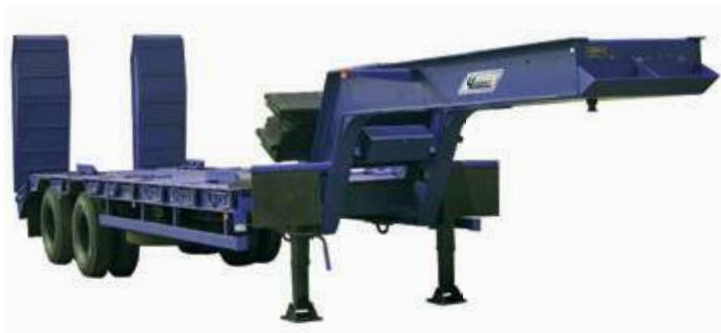
Полуприцеп-тяжеловоз предназначен для перевозки колёсной и гусеничной техники, а также других нестандартных грузов по дорогам I–V технических категорий. Модель снабжена механическими трапами, шириной 750 мм с механическими помощниками подъёма и опускания,
