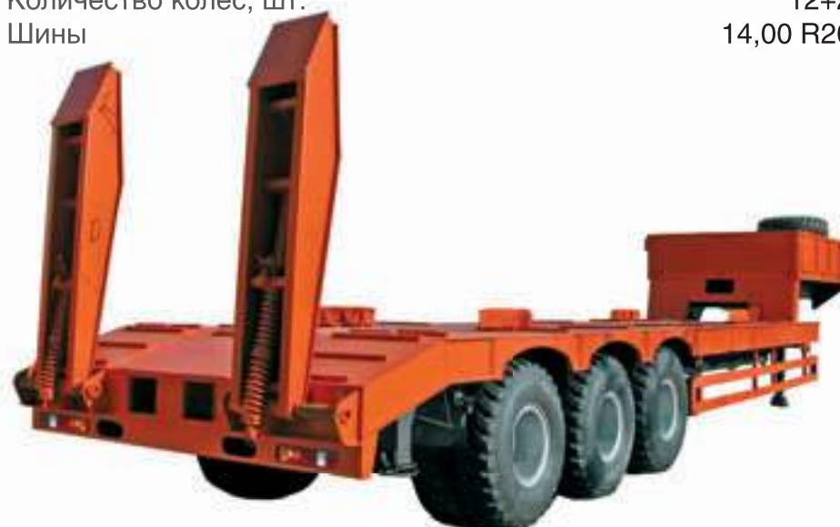
Полуприцеп-тяжеловоз предназначен для перевозки колесной и гусеничной техники, а также других нестандартных грузов по дорогам I–V технических категорий. Модель снабжена механическими трапами, оборудованными механическими помощниками подъема и опускания, для въезда на погрузочную платформу своим ходом под углом 14°. Кроме этого,
