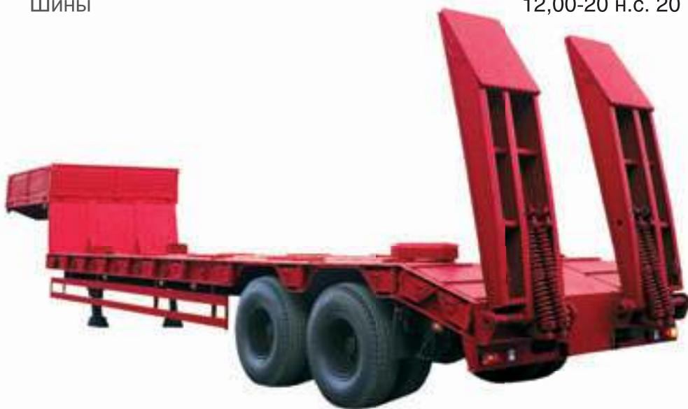
Полуприцеп-тяжеловоз предназначен для перевозки колесной и гусеничной техники, а также других нестандартных грузов по дорогам I–V технических категорий. Оснащен трапами с механическим помощником подъема-опускания, угол въезда по трапам 18 градусов. Снаряженная масса полуприцепа – 13 тонн.
